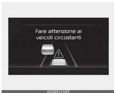
Nella seguente situazione, sul quadro strumenti verrà visualizzato il messaggio di avviso "Fare attenzione ai veicoli circostanti" e un avviso acustico verrà emesso per avvisare il conducente delle condizioni della strada che precede.
