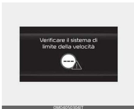
Quando il Sistema di riconoscimento intelligente dei limiti di velocità non funziona correttamente, comparirà il messaggio di avviso "Controlla il sistema del limite di velocità" sul quadro strumenti. In tal caso, si consiglia di far controllare la funzione da un concessionario/centro di assistenza partner autorizzato Kia.
