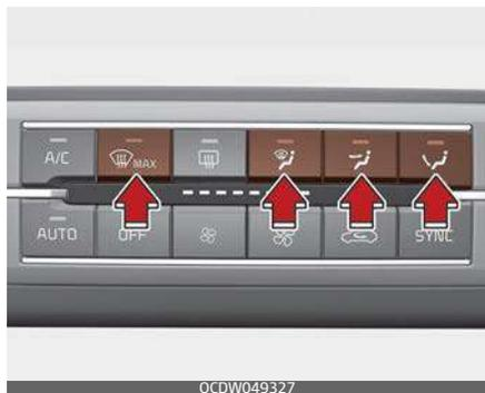
Il pulsante di selezione modo comanda la direzione del flusso di aria attraverso il sistema di ventilazione.
