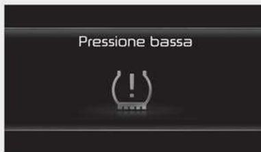
Quando gli indicatori spia del sistema di monitoraggio pressione pneumatici sono illuminati e viene visualizzato il messaggio spia sul display LCD quadro strumenti, vuol dire che uno o più pneumatici sono sotto-gonfiati in misura significativa. L'indicatore di pneumatico sgonfio segnala quale pneumatico risulta notevolmente sottogonfiato.
