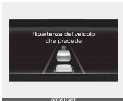
Quando un veicolo rilevato di fronte parte da una sosta, l'avviso di partenza del veicolo che precede informerà il conducente visualizzando sul quadro strumento il messaggio "Leading vehicle is driving away" (Il veicolo che precede sta partendo) ed emettendo un segnale acustico.
