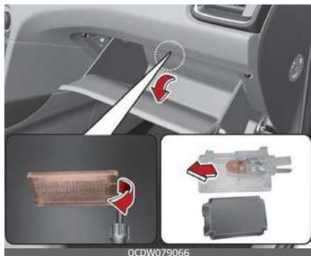
1. Usando un cacciavite a lama, fare leva sul gruppo lampada dall'interno.
