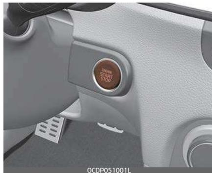
Il pulsante ENGINE START/STOP (Avviamento/arresto motore) si accende ogni volta che la porta anteriore viene aperta. La luce si spegnerà dopo circa 30 secondi dalla chiusura della porta. Inoltre si spegnerà immediatamente qualora il sistema allarme antifurto venga armato.
