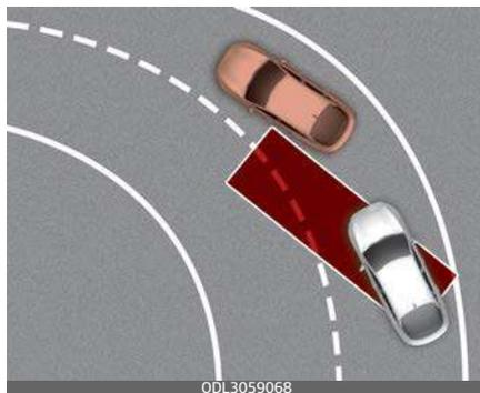
L'Assistenza anticollisione punti ciechi potrebbe non funzionare correttamente percorrendo una strada tortuosa. La funzione potrebbe rilevare un veicolo nella stessa corsia.
