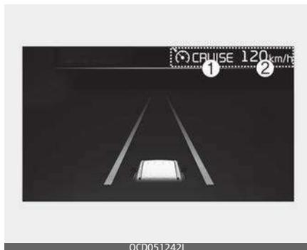
È possibile visualizzare lo stato di funzionamento dello Smart Cruise Control (Cruise Control intelligente) nella vista Assistenza alla guida sul quadro strumenti. Consultare "Quadro strumenti" a pagina 4-76.
