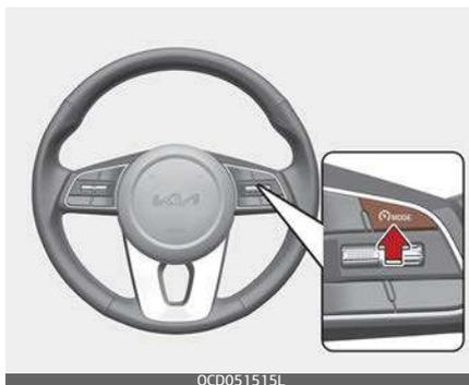
1. Per attivare la funzione, premere il pulsante Assistenza alla guida sul volante. La velocità impostata si illuminerà.
