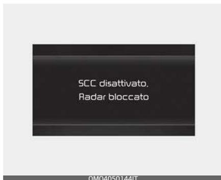
Quando la protezione o il sensore del radar anteriore è coperto da neve, pioggia o corpi estranei, questo può ridurre le prestazioni di rilevamento e limitare o disabilitare temporaneamente lo Smart Cruise Control (Cruise Control intelligente).
