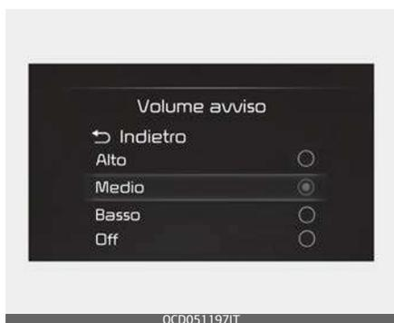
Con l'interruttore dell'accensione o il pulsante ENGINE START/STOP in posizione On, selezionare "User Settings → Driver Assistance → Warning Volume (Impostazioni utente → Assistenza conducente → Volume avviso)" sul display LCD o sul sistema di infotainment per cambiare il volume degli avvisi su 'Alto', 'Medio', 'Basso' o 'Off' (se la vibrazione del volante è in dotazione) per l'Assistenza anti collisione attraversamento da dietro.
