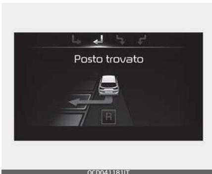
Mentre si guida in marcia avanti alla ricerca di uno spazio di parcheggio, comparirà il messaggio di cui sopra accompagnato da un bip sonoro qualora la ricerca sia stata completata. Arrestare il veicolo e cambiare nella posizione R (Retromarcia).
