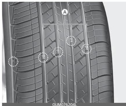
Ciò indica che lo spessore del battistrada rimasto sullo pneumatico è inferiore a 1,6 mm. In questo caso, sostituire il pneumatico.
