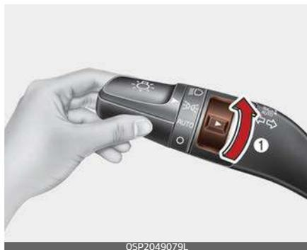
I fendinebbia sono usati per migliorare la visibilità in caso di scarsa visibilità dovuta a nebbia, pioggia o neve, ecc. I fendinebbia si accendono quando il relativo interruttore (1) viene portato su ON (ACC) dopo l'inserimento delle luci di posizione.
