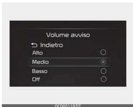
Con il pulsante ENGINE START/STOP (Avviamento/arresto motore) in posizione On, selezionare "User Settings → Driver Assistance → Warning Volume (Impostazioni utente → Assistenza conducente → Volume avviso)" sul display LCD o sul sistema di infotainment su 'Alto', 'Medio', 'Basso' o 'Off' (se la vibrazione del volante è equipaggiata) per Assistenza alla guida in autostrada.
