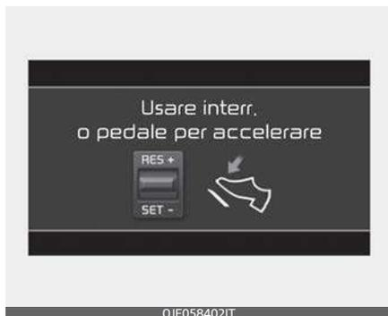
Se la modalità SCC è in funzione, il veicolo si arresta quando il veicolo davanti si arresta. Viene mostrato il messaggio sul cruscotto entro 3 secondi dall'arresto e la funzione sarà in standby.
