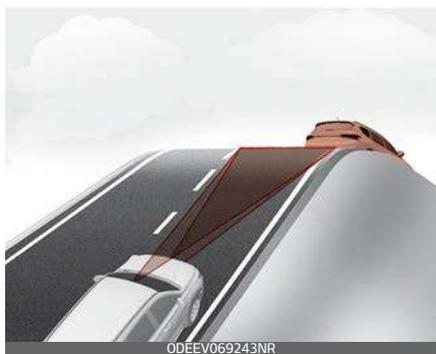
Durante la guida in salita o in discesa, lo Smart Cruise Control (Cruise Control intelligente) potrebbe non rilevare un veicolo in movimento nella vostra corsia e far accelerare il vostro veicolo per raggiungere la velocità impostata. Inoltre, la velocità si ridurrà rapidamente quando viene rilevato improvvisamente il veicolo che precede.
