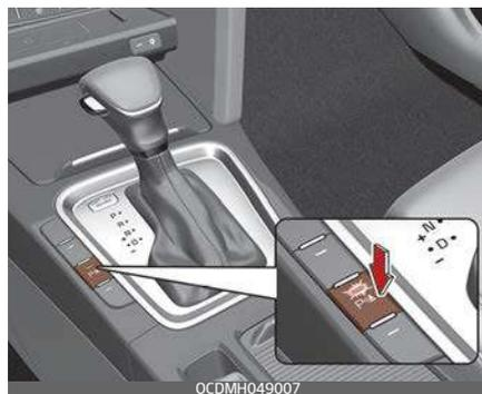
Premere il pulsante Parking Safety (P) per attivare l'avviso di distanza di parcheggio in retromarcia. Per disattivare la funzione, premere il pulsante nuovamente.
