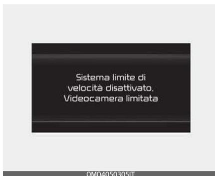
Quando il parabrezza sul quale è installata la camera per la visione anteriore è coperto da corpi estranei, come neve o pioggia, questo può ridurre le prestazioni di rilevamento e limitare temporaneamente o disabilitare il Sistema di riconoscimento intelligente dei limiti di velocità.
