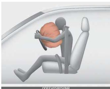
Il completo intervento dell'airbag, unitamente all'azione della cintura di sicurezza attutiscono l'impatto del conducente o del passeggero contro l'interno del veicolo, riducendo così il
