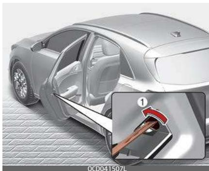
Se l'interruttore chiusura centralizzata non funziona elettricamente, sarà possibile bloccare le porte solamente estraendo la chiave di accensione dal relativo blocchetto.
