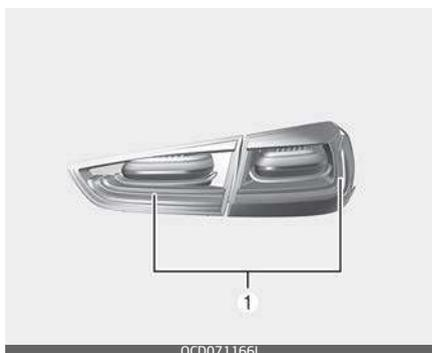
Se le luci di coda (Tipo a LED) (1) non funzionano, fare controllare il veicolo da un'officina professionale. Kia raccomanda di rivolgersi a un concessionario/partner di assistenza autorizzato Kia. La lampada a LED non può essere sostituita come componente singolo perché è un'unità integrata. Le luci a LED devono essere sostituite con l'unità integrata.
