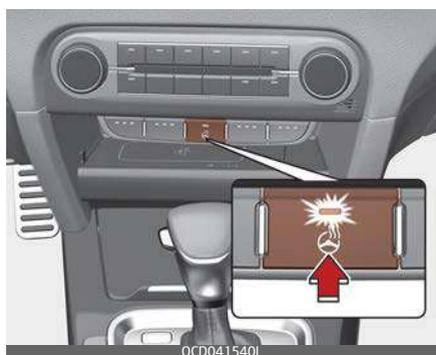
Quando l'interruttore di accensione o il pulsante ENGINE START/STOP (Avviamento/arresto motore) sono in posizione ON, premendo il pulsante del volante riscaldato si
