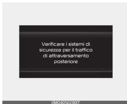
Quando l'Avviso collisione traffico di attraversamento posteriore non funziona correttamente, sul quadro strumenti apparirà il messaggio 'Verificare il sistema di sicurezza per il traffico di attraversamento posteriore' e la funzione si disattiverà automaticamente o sarà limitata. Si consiglia di far ispezionare il veicolo da un concessionario/centro di assistenza partner autorizzato Kia.
