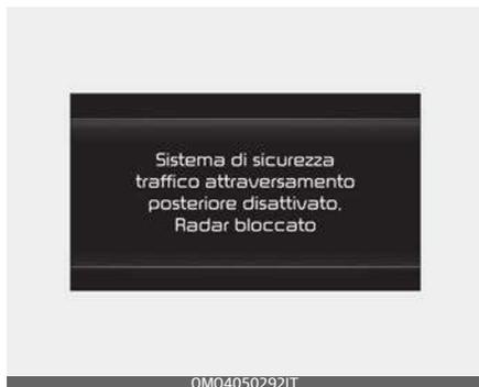
Quando il paraurti posteriore attorno al sensore radar angolare posteriore è coperto da materiale estraneo, come neve o pioggia, o quando si installa un carrello o un rimorchio, questo può ridurre le prestazioni di rilevamento e limitare temporaneamente o disabilitare l'Assistenza anticollisione traffico da attraversamento posteriore.
