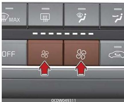
La velocità del ventilatore può essere impostata sulla velocità desiderata azionando la manopola di comando velocità ventilatore.
