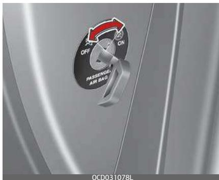
L'airbag frontale del passeggero può essere disattivato, agendo sull'interruttore airbag frontale del passeggero ON/OFF, qualora sul sedile del passeggero anteriore venga installato un seggiolino per
