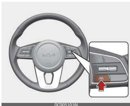
Per attivare/disattivare l'Assistenza di mantenimento della corsia, con
