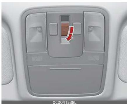
In alcune circostanze potrebbe essere necessario eseguire il resettaggio del funzionamento del tetto apribile. Alcuni casi in cui può essere necessario resettare il tetto apribile includono:
