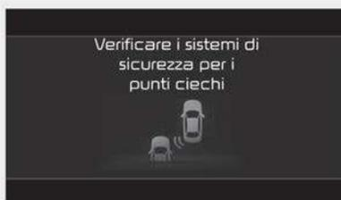
Quando l'Assistenza anti-collisione punti ciechi non funziona correttamente, appare il messaggio di avvertimento 'Check Blind-Spot Safety system (Verificare i sistema di sicurezza per i punti ciechi)' (si spegne dopo un certo tempo) e la
