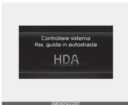
Quando l'Assistenza alla guida in autostrada non funziona adeguatamente, comparirà il messaggio di avviso di "Controllo del sistema di Assistenza alla guida in autostrada (HDA)" e sul quadro strumenti si accenderà la spia luminosa (⚠).
