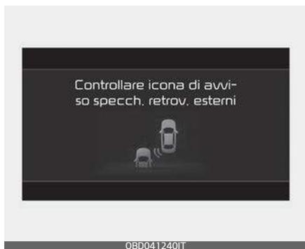
Quando la spia dello specchietto retrovisore esterno non funziona correttamente, il messaggio di avviso "Check side view mirror warning light (Controllare icona di avviso specch. retrov. esterni)" viene visualizzato sul quadro strumenti. Si consiglia di far ispezionare il veicolo da un concessionario/centro di assistenza partner autorizzato Kia.
