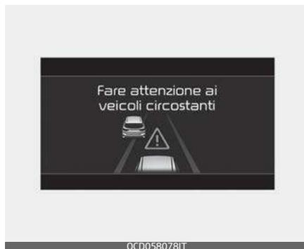
Se il veicolo davanti (velocità del veicolo: inferiore a 30 km/h) si sposta nella corsia accanto, la spia acustica suonerà e comparirà un messaggio. Regolare la velocità del veicolo nell'eventualità che veicoli od oggetti possano apparire improvvisamente davanti al veicolo, premendo il pedale freno a seconda della condizione della strada e alla condizione di guida.
