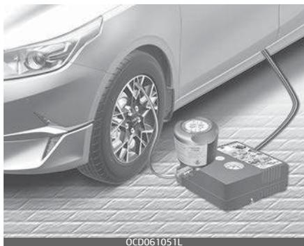
Con il kit di riparazione pneumatico (TMK) si può continuare a guidare anche con uno pneumatico forato.
