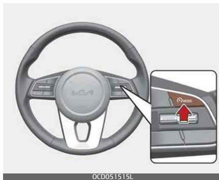
1. Premere due volte il pulsante di Assistenza alla guida sul volante, alla velocità desiderata. L'indicatore del limite di velocità si illuminerà sul quadro strumenti.
