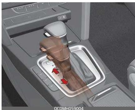
Sia a veicolo fermo che in movimento, il modo manuale viene selezionato spingendo la leva cambio dalla posizione D (Marcia avanti) al settore manuale. Per tornare ad usare il range D (Marcia avanti), spingere nuovamente la leva cambio nel settore principale.
