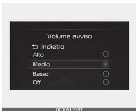
Con l'interruttore dell'accensione o il pulsante ENGINE START/STOP (Avviamento/arresto motore) in posizione On, selezionare "User Settings → Driver Assistance → Warning Volume (Impostazioni utente → Assistenza conducente → Volume avviso)" sul display LCD o sul sistema di infotainment per cambiare il volume degli avvisi su 'Alto', 'Medio', 'Basso' o 'Off' (se la vibrazione del volante è in dotazione) per l'Assistenza anti-collisione anteriore.
