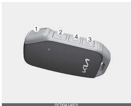
Tramite la chiave intelligente è possibile bloccare e sbloccare le porte (e il portellone) e avviare il motore senza dover inserire la chiave.
