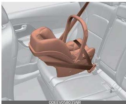
Un seggiolino per bambini rivolto all'indietro svolge la sua funzione di trattenuta avendo la superficie di seduta contro la schiena del bambino. Il sistema d'imbracatura trattiene il bambino in posizione e, in caso d'incidente, agisce in modo da mantenere in posizione il bambino nel seggiolino riducendo le sollecita-
