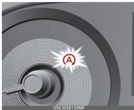
Si verifica un errore nei sensori del sistema ISG o nel sistema stesso.
