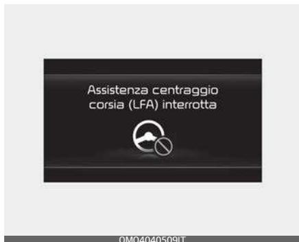
Se il conducente non ha ancora le mani sul volante dopo l'avviso per le mani staccate dal volante, apparirà il messaggio "Assistenza centraggio corsia (LFA) disattivata" e l'Assistenza centraggio corsia sarà automaticamente disattivata.
