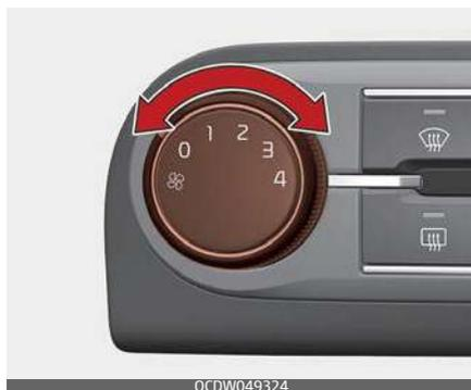
La manopola di regolazione della velocità del ventilatore permette di regolare la velocità del flusso d'aria che esce dal sistema di ventilazione.
