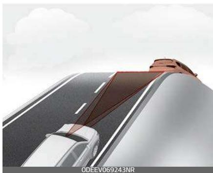
L'Assistenza anti-collisione anteriore potrebbe non rilevare un altro veicolo, pedone o ciclista di fronte durante la guida in salita o in discesa e questo potrebbe comportare l'assenza di avvisi o assistenza alla frenata quando necessario.
