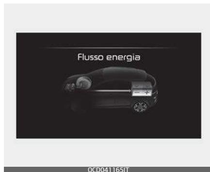
Il motore e il sistema a frenata rigenerativa carica la batteria ad alta tensione.
