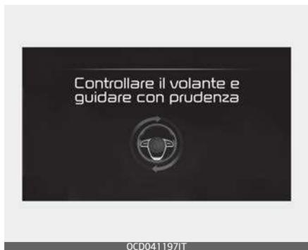
Quando l'assistenza fornita al conducente per uscire dallo spazio di parcheggio è stata completata, comparirà il messaggio di cui sopra.
