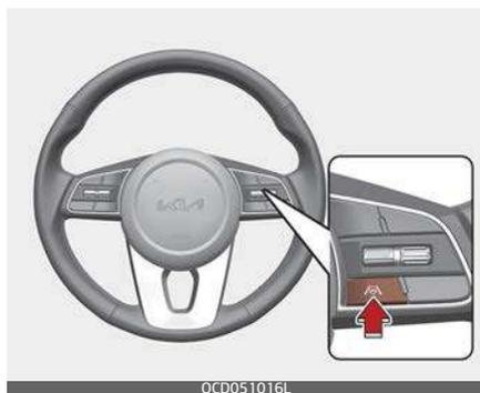
Con il commutatore di accensione o il pulsante ENGINE START/STOP (Avviamento/arresto motore) in posizione on, premere il pulsante Assistenza alla guida sul volante per attivare l'Assistenza centraggio corsia. La spia bianca o verde (🚗) si accende sul cluster.
