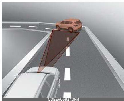
La velocità può essere ridotta a causa di un veicolo nella corsia adiacente.
