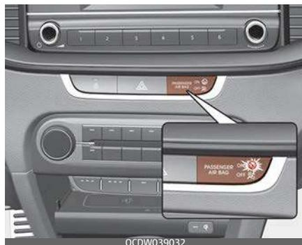
L'indicatore di attivazione dell'airbag anteriore del passeggero si accende per circa 4 secondi dopo che l'interruttore di accensione è stato portato in posizione ON.
