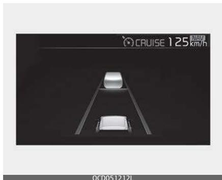
Se è necessaria una decelerazione temporanea nello stato di attesa e lo Smart Cruise Control basato sulla navigazione è in funzione, il simbolo verde (NAV) si accende sul cluster.
