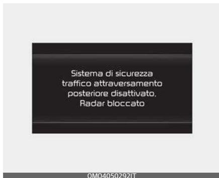
Quando il paraurti posteriore attorno al radar o al sensore laterale posteriore è coperto da materiale estraneo, come neve o pioggia, o quando si installa un carrello o un rimorchio, questo può ridurre le prestazioni di rilevamento e limitare temporaneamente o disabilitare il sistema di Avviso collisione traffico di attraversamento posteriore.
