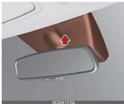
Il sistema di disappannamento automatico riduce la possibilità di appannamento del lato interno del parabrezza rilevando automaticamente l'umidità sul lato interno, così da poter aumentare il flusso d'aria diretto verso il parabrezza.
