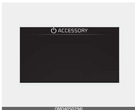
Premere il pulsante ENGINE START/STOP (Avviamento/arresto motore) mentre è in posizione OFF, senza premere il pedale della frizione.
