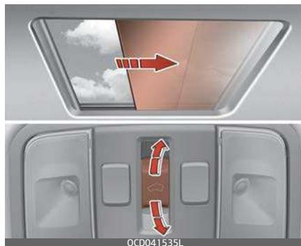
Usare il parasole elettrico per bloccare la luce solare diretta che passa attraverso il vetro del tettuccio.
