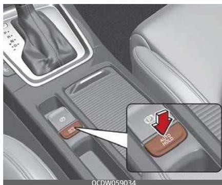
1. Con la porta del conducente, il cofano motore e il portellone chiusi, allacciare la cintura di sicurezza del conducente o premere il pedale del freno, quindi premere il pulsante Auto Hold. L'indicatore luminoso AUTO HOLD si accenderà e il sistema sarà in standby.
