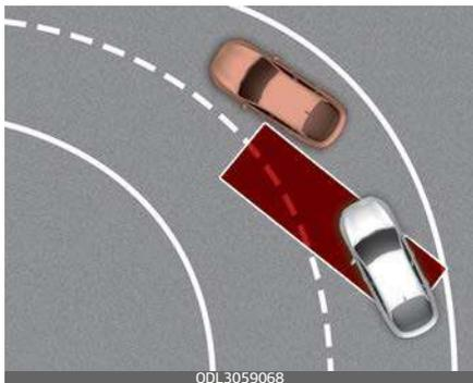
L'Assistenza collisione punto cieco potrebbe non funzionare correttamente percorrendo una strada tortuosa. La funzione potrebbe rilevare un veicolo nella stessa corsia.
