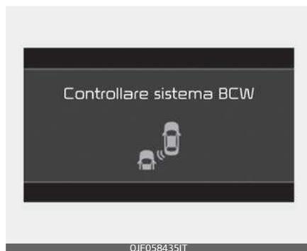
Quando l'Avviso anticollisione punti ciechi non funziona correttamente, il messaggio di avviso 'Check Blind-Spot Safety system (Verificare i sistemi di sicurezza per i punti ciechi)' apparirà sul quadro strumenti e la funzione di sicurezza dei punti ciechi si disattiverà automatica-
