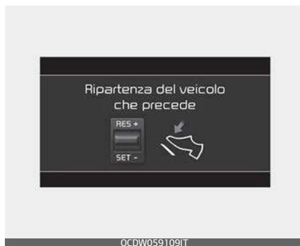
Se il conducente non intraprende alcuna azione per un determinato periodo di tempo dopo la partenza del veicolo davanti, viene mostrato il messaggio sul cruscotto.
