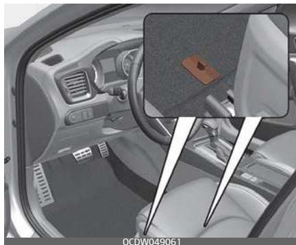
Quando si usa un tappetino sulla moquette anteriore, assicurarsi che si attacchi all'ancoraggio (agli ancoraggi) per tappetino del veicolo. Questo impedisce al tappetino di scivolare in avanti.
