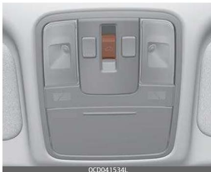
Il tetto apribile può essere utilizzato solo quando l'interruttore di accensione o il pulsante di ENGINE START/STOP (Avviamento/arresto motore) è in posizione ON o START.
