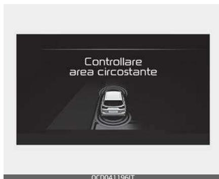
Il sistema di assistenza parcheggio controlla lo spazio anteriore e posteriore a disposizione per facilitare l'uscita del veicolo dall'area di parcheggio.
