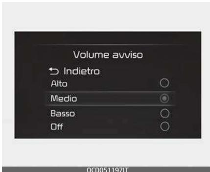
Con l'interruttore dell'accensione o il pulsante ENGINE START/STOP (Avviamento/arresto motore) in posizione On, selezionare "User Settings → Driver Assistance → Warning Volume (Impostazioni utente → Assistenza conducente → Volume avviso)" sul display LCD o sul sistema di infotainment per cambiare il volume degli avvisi su 'Alto', 'Medio', 'Basso' o 'Off' (se la vibra-
