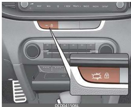
L'azionamento avviene mediante la pressione del pulsante di blocco/sblocco porte.
