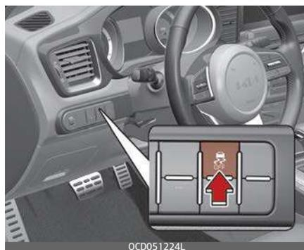
L'ESC applica la forza frenante sulle singole ruote e interagisce con il sistema di gestione del motore per stabilizzare il veicolo.
