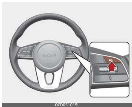
Premere il pulsante di Assistenza alla guida per disattivare il Cruise Control. L'indicatore Cruise si spegne.
