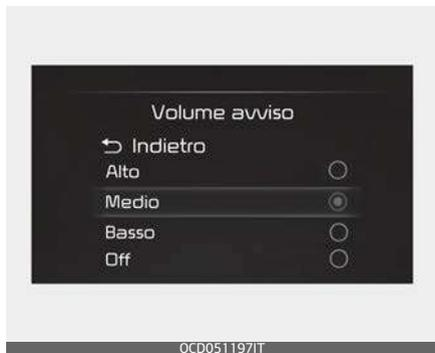
Selezionare "Impostazioni utente (Display LCD) o Impostazioni → Veicolo → (schermo sistema infotainment) → Assistenza conducente → Volume di avviso" per cambiare il volume dell'avviso su "Alto", "Medio", "Basso" o "Off (se la vibrazione del volante è equipaggiata)" per l'avviso di distanza di parcheggio avanti/indietro.
