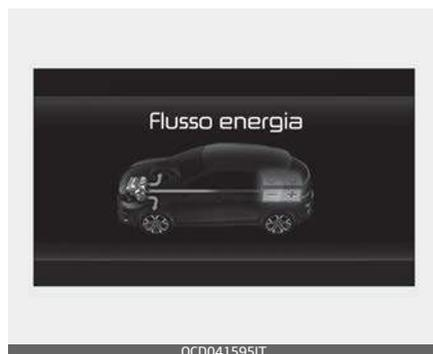
Sia il motore che la potenza della batteria sono utilizzati per guidare il veicolo.
