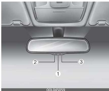
Lo specchietto retrovisore elettrico regola automaticamente l'effetto abbagliante provocato dai fari dei veicoli che seguono di notte o quando la luce è scarsa. Il sensore (3) presente nello specchietto rileva l'intensità luminosa all'esterno del veicolo e regola automaticamente l'effetto abbagliante provocato dai fari dei veicoli che seguono.
