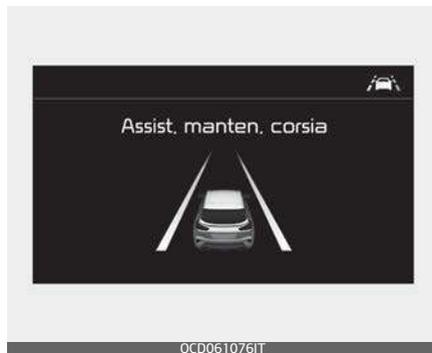
Corsia non rilevata (per CUV)
