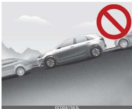
Il conducente deve premere il pedale dell'acceleratore e del freno in caso di parcheggio su strade inclinate. Se il conducente non è pratico nell'uso contemporaneo di acceleratore e pedale freno, potrebbe causare un incidente.
