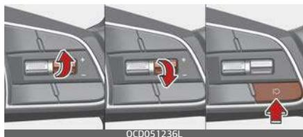
Se si preme il pulsante || ↻, la velocità del veicolo riprende alla velocità preimpostata. La velocità del veicolo deve essere superiore a 30 km/h per riattivare la funzione.
