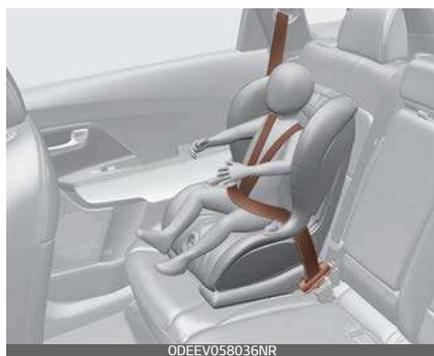
Un seggiolino per bambini rivolto in avanti provvede a trattenere il corpo del bambino con un'imbracatura. Tenere i bambini nel seggiolino per bambini rivolto in avanti con imbracatura fino a quando non raggiungono il limite di altezza o di peso consentito dal costruttore del seggiolino per bambini.
