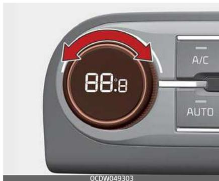
2. Ruotare la manopola di comando temperatura per impostare la temperatura desiderata.
