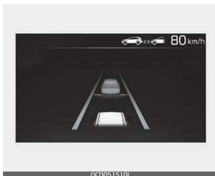
Se si desidera accelerare temporaneamente quando il Cruise control intelligente è attivo, premere il pedale dell'acceleratore. Mentre si preme il pedale dell'acceleratore, la velocità impostata, il livello di distanza e la distanza target lampeggiano sul quadro strumenti. Tuttavia, se il pedale dell'acceleratore non è sufficientemente premuto, il veicolo può rallentare.
