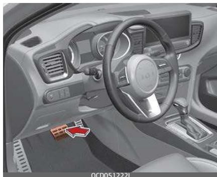
2. Quando il veicolo viene completamente arrestato premendo il pulsante del freno, l'indicatore luminoso AUTO HOLD passerà da bianco a verde.
