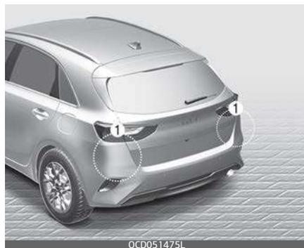
[1] : Sensore radar angolare posteriore
