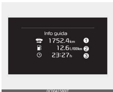
Vengono visualizzati: la distanza percorsa totale (1), il consumo medio di carburante (2) e il tempo di guida totale (3) una volta per ciascun ciclo di accensione.
