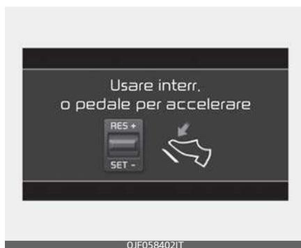
Nel traffico, il vostro veicolo si fermerà se il veicolo che vi precede si ferma; inoltre, se il veicolo che vi precede inizia a muoversi, anche il vostro veicolo partirà. Tuttavia, se il veicolo si ferma per più di 3 secondi, dovete premere il pedale dell'acceleratore o l'interruttore RES+ per iniziare a guidare. Se si preme l'interruttore SCC (RES+ o SET-) in modalità Auto Hold e il sistema SCC è in funzione, la funzione Auto Hold viene annullata indipendentemente
