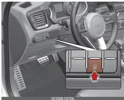
4. Verificare quindi che l'indicatore della pressione bassa dei pneumatici si spenga dopo aver lampeggiato per quattro secondi. In caso di quadro strumenti di supervisione, verificare che il messaggio "Pressione pneumatici memorizzata" sia visualizzato sul quadro strumenti.
