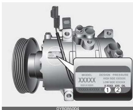
L'etichetta informa sul tipo di compressore installato, il modello, il codice fornitore, il numero di produzione, il refrigerante (1) e l'olio refrigerante (2).
