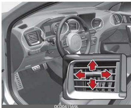
Le bocchette di uscita si possono aprire o chiudere separatamente usando la rotella zigrinata. Per chiudere la bocchetta, ruotarla verso il basso nella posizione massima. Inoltre, è possibile regolare la direzione dell'aria erogata da queste bocchette usando la leva di comando bocchetta come mostrato.
