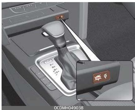
Chiudere saldamente tutte le porte e ruotare l'accensione su ACC o IGN ON. Per avviare la ricarica wireless, posizionare il telefono dotato di funzione di ricarica wireless sul pad di ricarica wireless.
