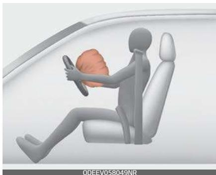
Al momento del gonfiaggio, le giunture a strappo praticate direttamente nei rivestimenti dei moduli si staccano per effetto della pressione prodotta dall'espansione degli airbag. L'ulteriore apertura dei rivestimenti consente quindi il completo gonfiamento degli airbag.
