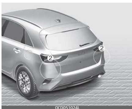
[1] : Telecamera anteriore, [2] : Radar angolare posteriore
