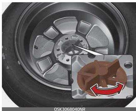
Girare in senso antiorario il dado ad alette che mantiene fermo lo pneumatico, per rimuoverlo. Per riporre lo pneumatico procedere in ordine inverso rispetto alla rimozione.
