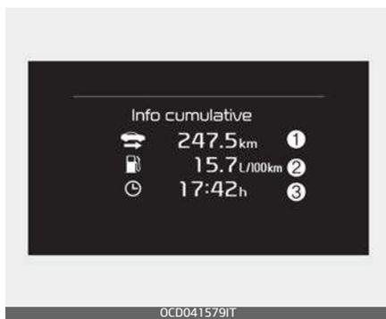
Questo display mostra la distanza di viaggio accumulata (1), il rendimento medio del carburante (2) e il tempo di guida totale (3) dopo il rifornimento.
