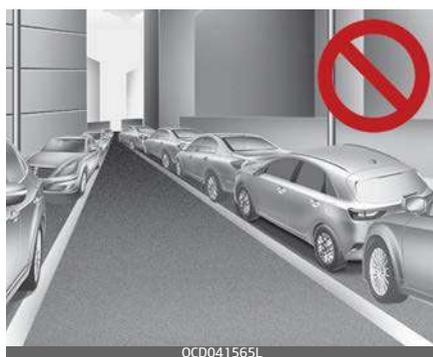
Quando si esce da uno spazio di parcheggio stretto e vicino a un muro, la funzione potrebbe non operare a dovere. Quando si esce da uno spazio di parcheggio simile a quello mostrato nella figura sopra, il conducente deve controllare se ci sono ostacoli mentre esce.
