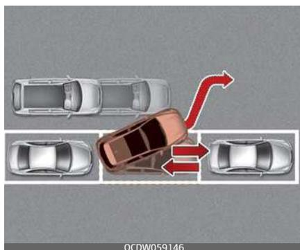
Il sistema di assistenza parcheggio aiuta il conducente a parcheggiare il veicolo usando sensori per misurare gli spazi di parcheggio, controllando il volante per parcheggiare il veicolo in modo semiautomatico e fornendo istruzioni sul display LCD per aiutare durante l'intera manovra di parcheggio.
