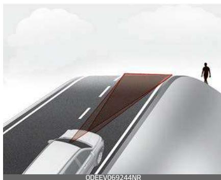
L'Assistenza anti-collisione anteriore può rilevare un veicolo o un pedone nella corsia vicina o fuori dalla corsia se si percorre una strada tortuosa. In tal caso, il sistema può inviare un allarme al guidatore e applicare il freno sebbene ciò non sia necessario. Controllare sempre le condizioni del traffico attorno al veicolo.
