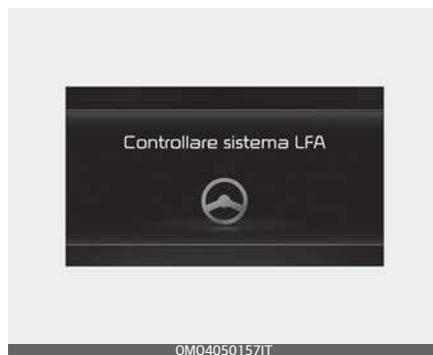
Quando il Assistenza centraggio corsia non funziona correttamente, il messaggio di avviso 'Check Lane Following Assist (LFA) system (Controllare sistema LFA)' apparirà sul quadro strumenti (si spegne dopo un certo tempo) e la spia
