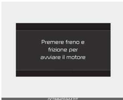
Quando la leva del cambio non è in posizione N (Folle), sul cruscotto viene visualizzato il messaggio seguente.
