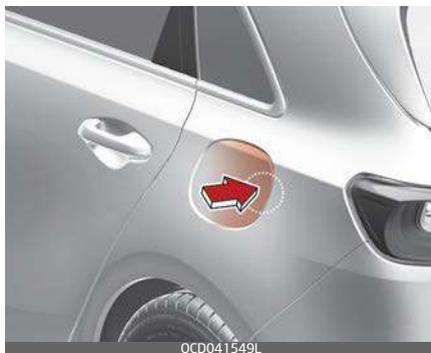
1. Per aprire lo sportello di rifornimento carburante, premere il bordo in corrispondenza delle "ore 3".
