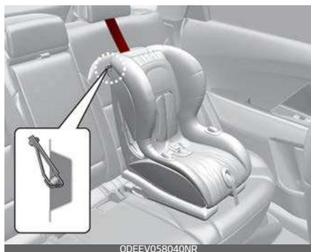
1. Far passare la cinghia con ancoraggio flessibile del seggiolino sopra lo schienale. Per il posizionamento della cinghia con ancoraggio flessibile, seguire la procedura indicata dal produttore del seggiolino di sicurezza per bambini.
