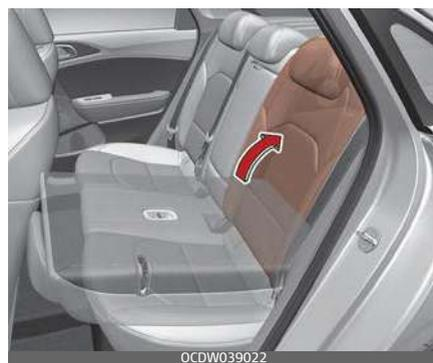
1. Per utilizzare lo schienale del sedile posteriore, sollevarlo e tirarlo verso dietro. Tirare con forza lo schienale fino a innestarlo a fine corsa. Assicurarsi che lo schienale sia bloccato in posizione. Quando si riporta lo schienale sedile in posizione dritta, assicurarsi sempre che sia bloccato in posizione esercitando pressione sulla spalla dello schienale sedile medesimo.
