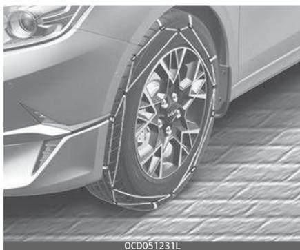
Dato che i fianchi degli pneumatici radiali sono più sottili, l'installazione di alcuni tipi di catene da neve potrebbe danneggiare gli pneumatici. Pertanto è preferibile usare pneumatici da neve anziché catene da neve. Non montare catene per pneumatici su veicoli equipaggiati con ruote in alluminio; le catene da
