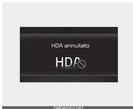
Se il conducente non ha ancora le mani sul volante dopo l'avviso, appare il messaggio di avviso "Assistenza alla guida in autostrada (HDA) disattivata" e la funzione sarà automaticamente disattivata.
