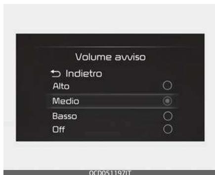
Con l'interruttore di accensione o il pulsante ENGINE START/STOP in posizione ON, e selezionare 'Impostazioni utente (display LCD) o Impostazioni → Veicolo (schermata Sistema Infotainment) → Assistenza alla guida → Volume degli avvisi' per cambiare il Volume degli avvisi su 'Alto', 'Medio', 'Basso' o 'Off' (se la vibrazione del volante è dotata) per l'Avviso uscita di sicurezza.
