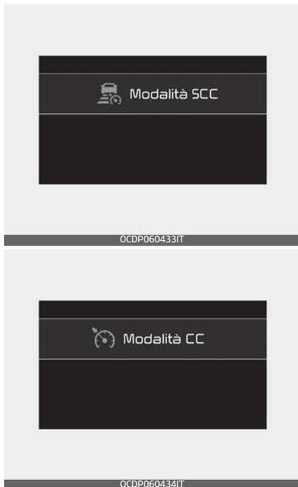
Il conducente può scegliere di usare solo la modalità CC (funzione di controllo velocità) agendo come segue:
