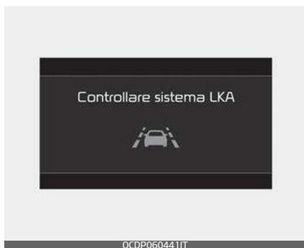
Quando l'Assistenza mantenimento corsia non funziona correttamente, viene visualizzato il messaggio "Controllare il sistema Assistenza mantenimento corsia (LKA)" e sul quadro strumenti si accende la spia gialla dell'indicatore ( / \ o / \ ). In tal caso, far controllare la funzione da
