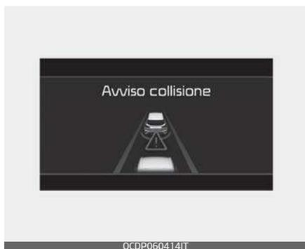
Mentre lo Smart Cruise Control (Cruise Control intelligente) è in funzione, quando il rischio di collisione con il veicolo che precede è alto, il messaggio di avviso "Avviso collisione" verrà visualizzato sul quadro strumenti, e un avviso acustico avvertirà il conducente. Prestare sempre attenzione alla strada mentre si guida e, se necessario, premere il pedale del freno per ridurre la velocità di guida, al fine di mantenere la distanza di sicurezza.
