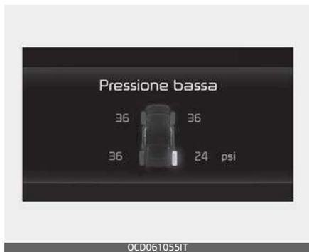
Quando gli indicatori spia del sistema di monitoraggio pressione pneumatici sono illuminati e viene visualizzato il messaggio spia sul display LCD quadro strumenti, vuol dire che uno o più pneumatici sono sotto-gonfiati in misura significa-
