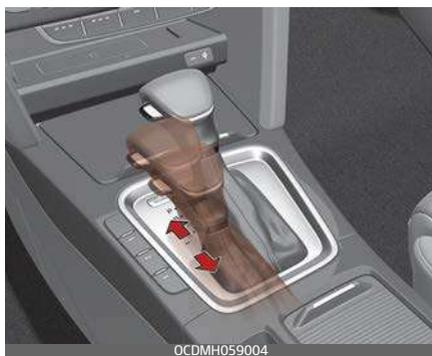
Sia a veicolo fermo che in movimento, la modalità sportiva viene selezionata spingendo la leva del cambio dalla posizione D (Marcia avanti) al settore manuale. Per tornare ad usare il range D (Marcia avanti), spingere nuovamente la leva cambio nel settore principale.
