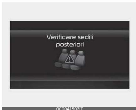
È possibile attivare o disattivare il sistema di avviso occupante posteriore selezionando "Impostazioni utente (display LCD) o Impostazioni → Veicolo (schermata Sistema Infotainment) → Comodità → Avviso occupante posteriore".
