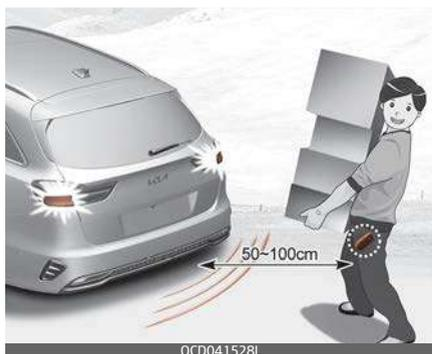
Se ci si trova nell'area di rilevamento (50~100 cm dietro il veicolo) portando con sé una chiave intelligente, le luci di emergenza lampeggeranno e il carillon suonerà per circa 3 secondi per avvisare che la chiave intelligente è stata rilevata per cui il portellone si aprirà.
