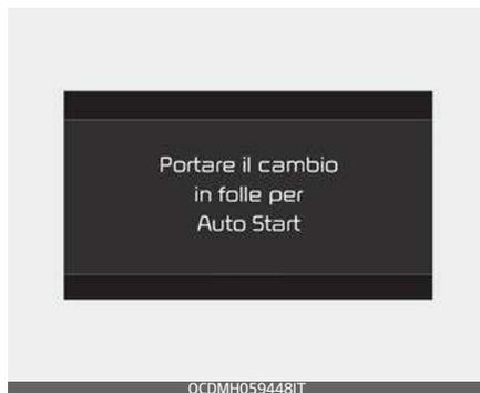
**Cambio automatico/Trasmissione a doppia frizione** - Mettere la leva
