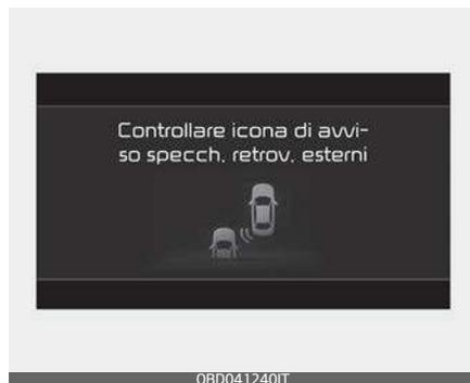
Quando la spia dello specchietto retrovisore esterno non funziona correttamente, sul quadro strumenti viene visualizzato il messaggio di avviso 'Check side view mirror warning light' (Controllare icona di avviso specch. retrov. esterni). Si consiglia di far ispezionare il veicolo da un concessionario/centro di assistenza partner autorizzato Kia.
