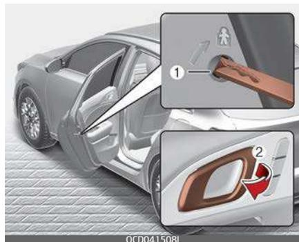
La sicura per bambini ha la funzione di prevenire che i bambini possano aprire accidentalmente le porte posteriori dall'interno del veicolo. Le sicure delle porte posteriori devono essere usate ogni qualvolta vi sono bambini a bordo del veicolo.
