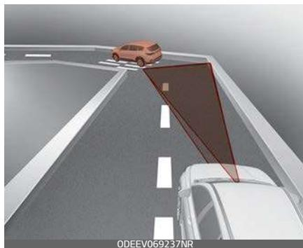
Nelle curve, lo Smart Cruise Control (Cruise Control intelligente) potrebbe non rilevare un veicolo nella stessa corsia, e potrebbe accelerare per raggiungere la velocità impostata. Inoltre, la velocità si riduce rapidamente quando viene rilevato improvvisamente il veicolo che precede.
