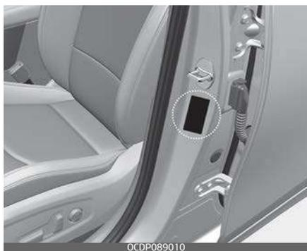
L'etichetta di omologazione del veicolo fissata sul montante centrale lato guida (o lato passeggero) riporta il numero di identificazione del veicolo (VIN).
