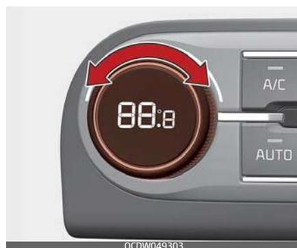
Ruotando la manopola completamente verso destra, la temperatura aumenta fino al valore massimo (HI).
