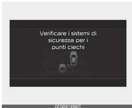
Quando l'avviso di uscita sicura non funziona correttamente, il messaggio di avviso 'Check Blind-Spot Safety system (Verificare i sistemi di sicurezza per i punti ciechi)' apparirà sul cluster per alcuni secondi e la spia principale (⚠) si accenderà sul cluster. In tal caso, far ispezionare il veicolo da un'officina professionale. Kia consiglia di rivolgersi a un concessionario/centro di assistenza partner autorizzato Kia.
