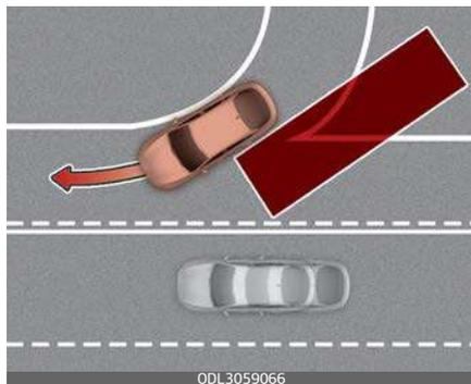
L'Assistenza collisione punto cieco potrebbe non funzionare correttamente durante la guida in prossimità di bivi o confluenze. La funzione potrebbe non rilevare il veicolo nella corsia adiacente.
