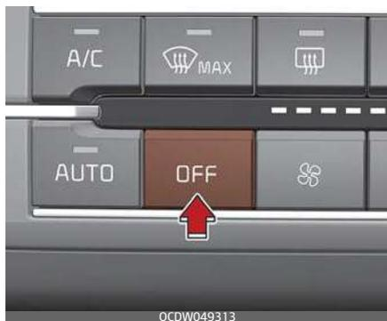
Per spegnere il climatizzatore, premere il pulsante OFF. Finché il commutatore di accensione è in posizione ON, i pulsanti della distribuzione dell'aria e dell'ingresso dell'aria rimangono attivi.
