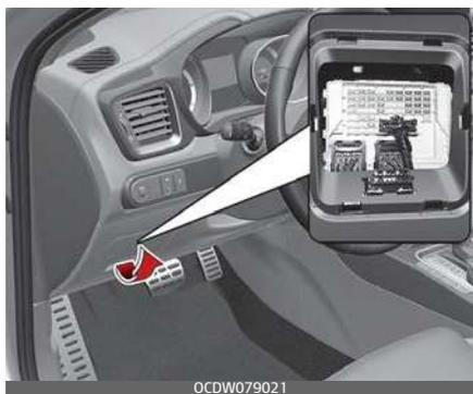
3. Estrarre il fusibile sospetto tenendolo dritto. Usare l'attrezzo estrattore presente sul pannello fusibili vano motore.
