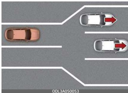
Se si supera un casello o un incrocio con molti veicoli o si guida dove le corsie sono unite o separate frequentemente, l'Avviso di partenza del veicolo che precede potrebbe non funzionare correttamente.
