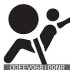
La funzione della spia airbag presente nel quadro strumenti è quella di segnalare la presenza di un potenziale problema relativo al sistema di sicurezza passiva supplementare (SRS) airbag.
