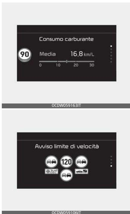
Le informazioni sui limiti di velocità vengono visualizzate sul quadro strumenti.
