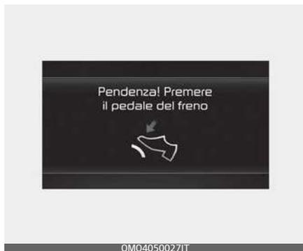
Questo messaggio di avvertenza compare quando il veicolo viene guidato a bassa velocità su una forte pendenza e l'apparecchiatura rileva che non viene utilizzato il pedale del freno.
