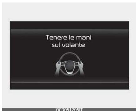
L'avviso mani staccate dal volante appare quando la funzione rileva che le mani del conducente non sono sul volante mentre l'Assistenza alla guida in autostrada è in funzione.
