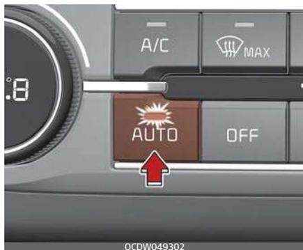
1. Premere il pulsante AUTO. I modi, le velocità del ventilatore, la presa aria e il condizionamento aria verranno controllati automaticamente in funzione della temperatura impostata.
