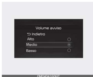
Selezionare "Settings → Driver Assistance → Warning Volume" (Impostazioni → Assistenza alla guida → Volume di avviso) dal quadro strumenti o dal sistema di infotainment per modificare il volume di avviso su "High", "Medium", "Low" (Alto, Medio o Basso) per il Sistema di segnalazione distanza di parcheggio in retromarcia.
