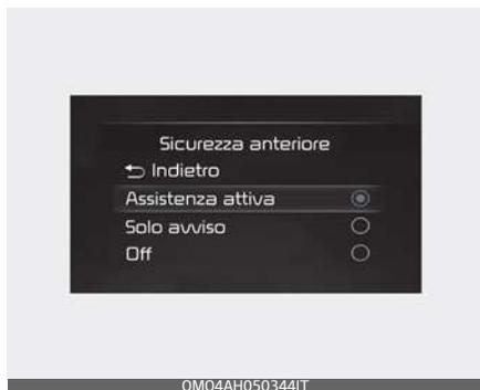
Con il pulsante ENGINE START/STOP (avviamento/arresto motore) in posizione ON, selezionare o deselezionare "Driver Assistance → Forward Safety" (Assistenza al conducente → Sicurezza anteriore) nel menu delle impostazioni per stabilire se avvalersi o meno di ciascuna funzione.
