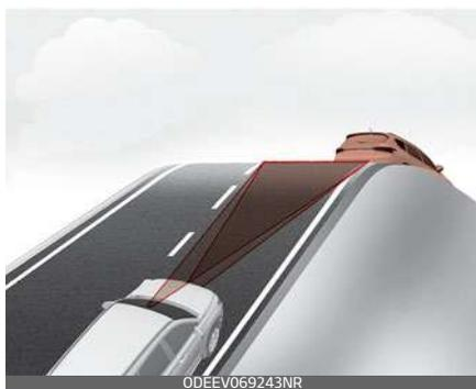
Durante la guida in salita o in discesa, lo Smart Cruise Control (Cruise Control intelligente) potrebbe non rilevare un veicolo in movimento nella vostra corsia e far accelerare il vostro veicolo per raggiungere la velocità impostata. Inoltre, la velocità del veicolo diminuirà di colpo se il veicolo davanti viene rilevato improvvisamente.
