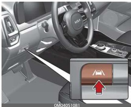
Con il pulsante Start/Stop del motore in posizione ON, premere il pulsante "Lane Safety" ("Sicurezza corsia") sul pannello degli strumenti per attivare l'Assistenza al mantenimento della corsia. La spia bianca (🚗) si accenderà sul quadro strumenti.
