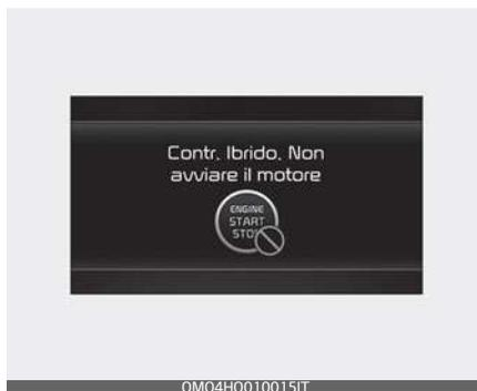
Questo messaggio viene visualizzato quando il livello di alimentazione della batteria ibrida (SOC) è basso. Si attiva il cicalino finché il problema non viene risolto. Astenersi dal guidare quando è visualizzato il messaggio spia.
