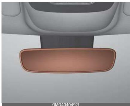
Il sensore presente nello specchietto rileva l'intensità luminosa all'esterno del veicolo e regola automaticamente l'effetto abbagliante provocato dai fari dei veicoli che seguono.
