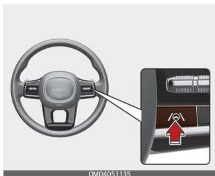
Con il pulsante Start/Stop del motore in posizione ON (Acceso), premere brevemente il pulsante dell'Assistenza alla guida in corsia sul volante per attivare l'Assistenza al centraggio della corsia. Sul quadro strumenti si accenderà la spia (🚦) bianca o verde.
