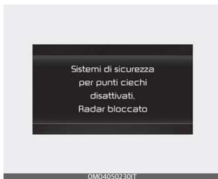
Quando il paraurti posteriore attorno al sensore radar angolare o al sensore posteriore è coperto da materiale estraneo, come neve o pioggia, o quando si installa un carrello o un rimorchio, questo può ridurre le prestazioni di rilevamento e limitare temporaneamente o disabilitare l'Assistenza per l'uscita sicura dal veicolo.
