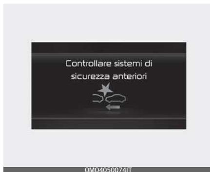
Quando l'Assistenza anti-collisione anteriore non funziona correttamente, compare il messaggio di avviso e le spie (⚠) e (🚗) si illuminano sul quadro strumenti. Far ispezionare la funzione da un concessionario autorizzato Kia.
