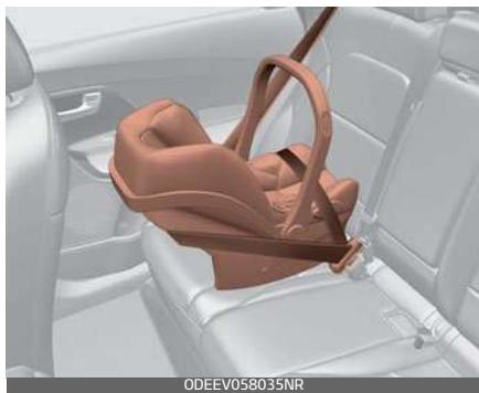
Un seggiolino per bambini rivolto all'indietro svolge la sua funzione di trattenuta avendo la superficie di seduta contro la schiena del bambino. Il sistema d'imbracatura trattiene il bambino in posizione e, in caso d'incidente, agisce in modo da mantenere in posizione il bambino nel seggiolino riducendo le sollecitazioni sul fragile collo e sulla colonna vertebrale del bambino.
