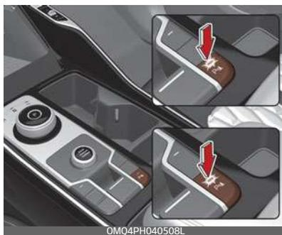
Premere il pulsante Sicurezza durante il parcheggio (P) per attivare o disattivare l'Avviso di distanza di parcheggio in marcia avanti/retromarcia.
