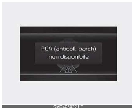
Quando il sistema di Assistenza anti-collisione per il parcheggio in retromarcia o altre funzioni correlate non funzionano correttamente, viene visualizzato sul quadro strumenti il messaggio "Check Parking Collision-Avoidance Assist system" (Controllare sistema di assistenza anticollisione per il parcheggio), e la funzione si disattiva automaticamente. Far ispezionare il proprio veicolo da un concessionario autorizzato Kia.
