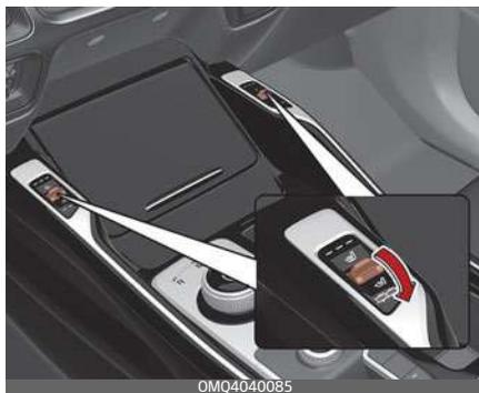
La temperatura del sedile viene regolata in funzione della posizione delle leve.
