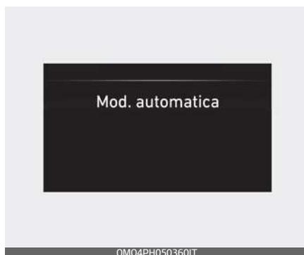
La modalità di guida sarà selezionata automaticamente dal sistema tra, in alternativa, Electric (CD) o Hybrid (CS), a seconda delle condizioni di guida.
