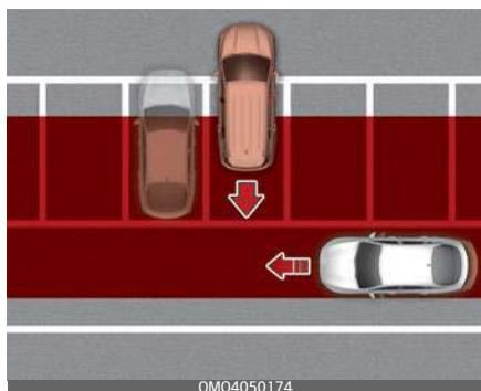
Assistenza anti collisione attraversamento da dietro potrebbe rilevare veicoli che passano dietro al proprio veicolo quando si parcheggia in retromarcia in un parcheggio. Se questo si verifica, la funzione potrebbe avvisare il conducente senza necessità e controllare i freni.
