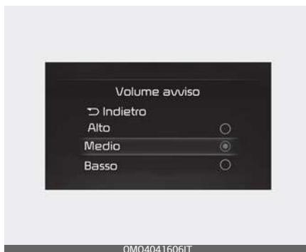
Con il pulsante Start/Stop del motore in posizione ON (Acceso), selezionare "Driver Assistance → Warning Volume" ("Assistenza conducente → Volume avviso") nel menu Impostazioni per impostare il volume dell'avviso su "High", "Medium", "Low" ("Alto", "Medio" o "Basso") per l'Assistenza al mantenimento della corsia.
