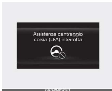
Se il conducente non ha ancora le mani sul volante dopo l'avviso per le mani staccate dal volante, apparirà il messaggio "Assistenza centraggio
