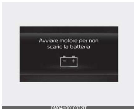
Questo messaggio appare per informare il conducente che la batteria a 12V si può scaricare il pulsante ENGINE START/STOP (avviamento/arresto motore) è in posizione ON (senza l'indicatore
