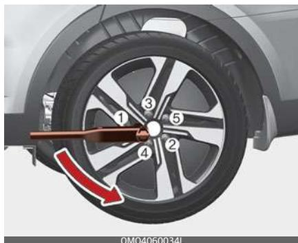
6. Allentare di un giro in senso antiorario tutti i dadi della ruota, ma non rimuoverli prima di aver sollevato da terra il veicolo.
