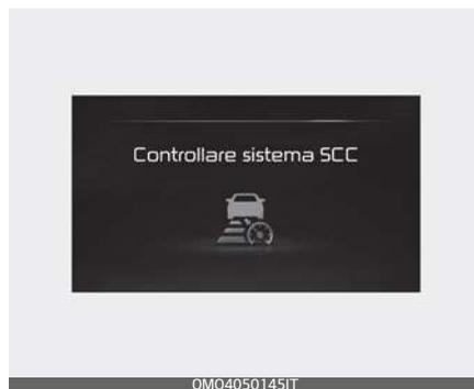
Quando lo Smart Cruise Control (Cruise Control intelligente) non funziona correttamente, verrà visualizzato il messaggio di avviso "Check SCC (Smart Cruise Control) system" ["Controllare sistema Smart Cruise Control (SCC)"] e la spia (⚠) si accenderà sul quadro strumenti. Far ispezionare la funzione da un concessionario autorizzato Kia.
