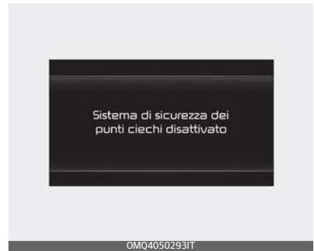
Quando il motore viene riavviato, con la funzione disattivata, sul quadro strumenti apparirà il messaggio 'Blind-Spot Safety System is Off' (Sistema di sicurezza punti ciechi disattivato).
