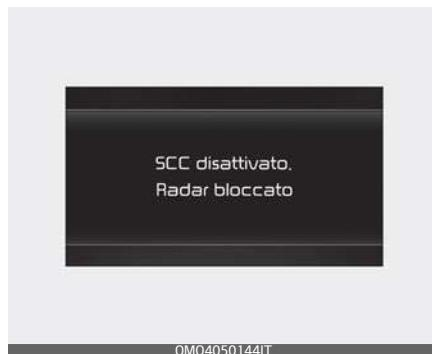
Quando la protezione o il sensore del radar anteriore è coperto da neve, pioggia o materiale estraneo, questo può ridurre le prestazioni di rilevamento e limitare o disabilitare temporaneamente lo Smart Cruise Control (Cruise Control intelligente).
