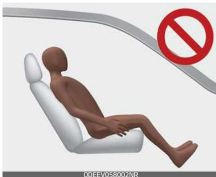
Durante l'incidente, se lo schienale del sedile anteriore è reclinato, il bacino dell'occupante può scivolare sotto la parte addominale della cintura di sicurezza subendo una forte pressione sull'addome. Ciò potrebbe causare lesioni interne serie o fatali. Il conducente deve informare il passeggero anteriore che, quando il veicolo è in marcia, è necessario mantenere il sedile in posizione eretta.
