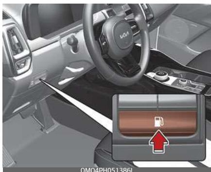
2. Attendere che la pressione del serbatoio carburante venga scaricata. Questo messaggio viene visualizzato quando si sblocca lo sportello del bocchettone di rifornimento con il serbatoio del carburante depressurizzato.
