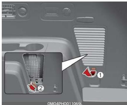
Se il connettore di carica non si scollega perché la batteria si è scaricata e/o a causa di un guasto al sistema elettrico, aprire il coperchio (1) sul lato destro del vano bagagli e tirare leggermente il cavo di emergenza (2). Il connettore di carica si collegherà.
