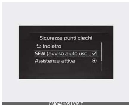
Con il pulsante ENGINE START/STOP (avviamento/arresto motore) in posizione ON, selezionare "Driver Assistance → Blind-Spot Safety → Safe Exit Warning" ("Assistenza conducente → Sicurezza dei punti ciechi → Avviso per l'uscita sicura dal veicolo") nel menu Impostazioni per attivare l'Avviso per l'uscita sicura dal veicolo, e deselezionare per disattivare la funzione.
