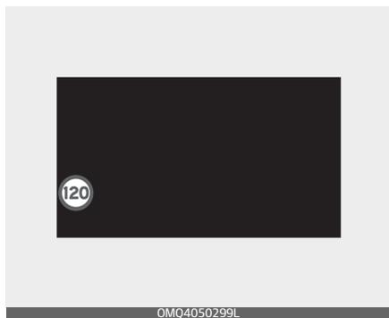
Quando si procede ad una velocità superiore rispetto a quella del limite di velocità visualizzato, l'indicatore rosso del limite di velocità lampeggerà.
