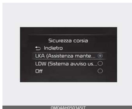
Con il pulsante ENGINE START/STOP (avviamento/arresto motore) in posizione ON, selezionare o deselezionare "Driver Assistance → Lane Safety" (Assistenza conducente → Sicurezza corsia) nel menu delle impostazioni per stabilire se avvalersi o meno di ciascuna funzione.
