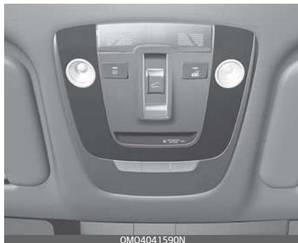
Il tetto apribile può essere utilizzato solo quando l'interruttore di accensione o il pulsante di avviamento/arresto motore è in posizione ON o START.
