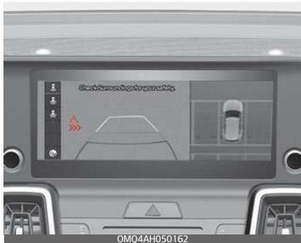
posteriore sinistro/destro del proprio veicolo, la spia di avviso sullo specchietto laterale lampeggerà e sul quadro strumenti verrà visualizzato un messaggio di avviso. Contemporaneamente si attiverà un segnale acustico. Se il Monitor retrovisore è in funzione, verrà visualizzato un avviso anche sullo schermo del sistema di Infotainment.
