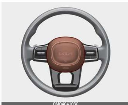
L'avvisatore acustico opererà solo premendo quest'area. Controllare periodicamente l'avvisatore acustico per assicurarsi che funzioni a dovere.
