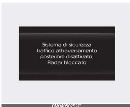
Quando il paraurti posteriore attorno al sensore radar angolare o al sensore posteriore è coperto da materiale estraneo, come neve o pioggia, o quando si installa un carrello o un rimorchio, questo può ridurre le prestazioni di rilevamento e limitare temporaneamente o disabilitare Assistenza anti collisione attraversamento da dietro.
