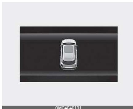
Se il conducente spegne il motore quando il tetto apribile non è completamente chiuso, il segnale acustico di avvertimento si attiverà per vari secondi e sul display LCD del quadro strumenti apparirà il messaggio di tetto apribile aperto.
