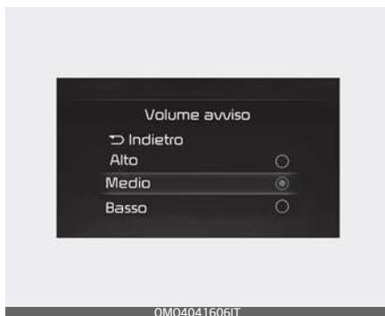
Con il pulsante Start/Stop del motore in posizione ON (Acceso), selezionare "Driver Assistance → Warning Volume" ("Assistenza conducente → Volume avviso") nel menu Impostazioni per impostare il volume dell'avviso su "High", "Medium" o "Low" ("Alto", "Medio" o "Basso") per l'Assistenza parcheggio intelligente a distanza.
