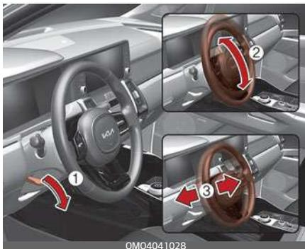
1. Per modificare l'angolo del volante, tirare verso il basso la leva di sblocco del dispositivo di blocco (1).
