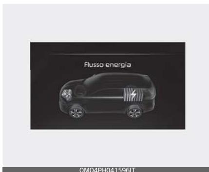
Quando il veicolo è fermo, la batteria ad alta tensione è caricata dal motore termico.
