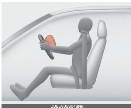
I moduli airbag sono situati sia nel centro del volante che nel pannello lato passeggero anteriore, al di sopra del cassetto plancia. Quando la SRSCM rileva un impatto frontale sufficientemente violento, farà automaticamente dispiegare gli airbag frontali.
