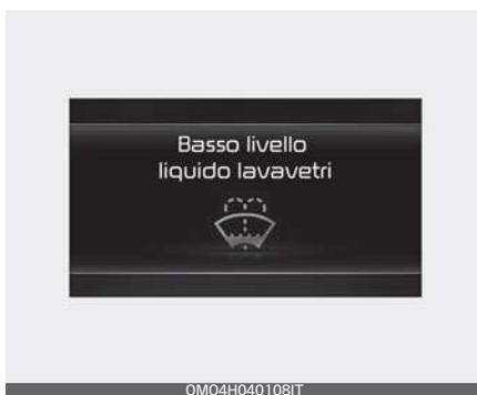
Questo messaggio appare se il fluido lavavetri nel serbatoio è quasi esaurito.
