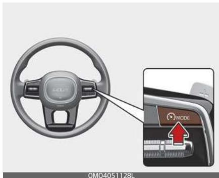
Premere il pulsante dell'Assistenza alla guida (Ⓜ MODE) per disattivare l'Assistente limite di velocità manuale. L'indicatore del limite di velocità si spegne.
