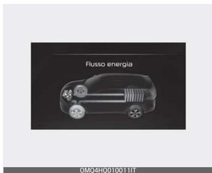
Il freno motore lavora per decelerare il veicolo e per ricaricare la batteria ad alta tensione, contemporaneamente.
