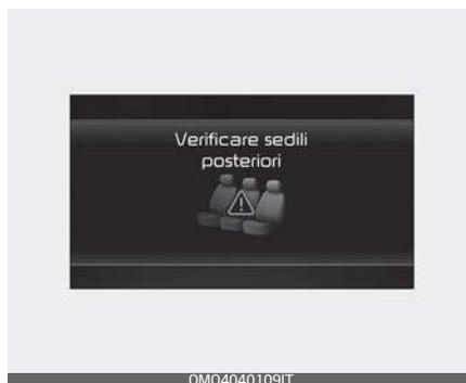
È possibile attivare o disattivare l'ROA dal Modo Impostaz. Utente sul display LCD. Se il veicolo è dotato di un sistema di infotainment, è possibile apprendere le modalità di configurazione sul sito web tramite codice QR nella guida di riferimento rapido di infotainment.
