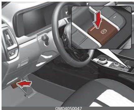
Rilascio del freno di stazionamento con l'interruttore EPB,
