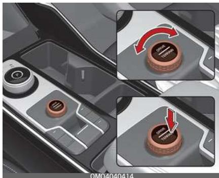
Si può passare da DRIVE MODE a TERRAIN mode premendo il pulsante DRIVE/TERRAIN mode e poi selezionare SNOW, MUD, o SAND mode
