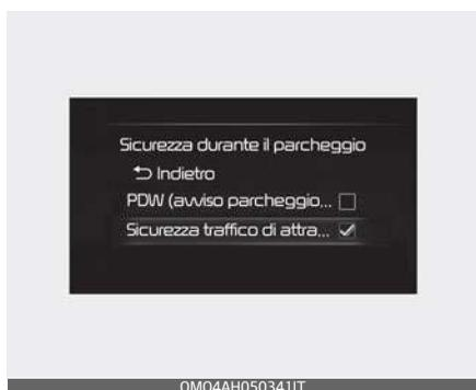
Con il pulsante ENGINE START/STOP è in posizione ON, selezionare "Driver Assistance → Paking Safety → Rear Cross-Traffic Safety" (Assistenza Conducente → Sicurezza durante il parcheggio → Sicurezza traffico di attraversamento posteriore) nel menu Impostazioni per attivare l'Assistenza anti collisione attraversamento da dietro e deselezionare per disattivare la funzione.
