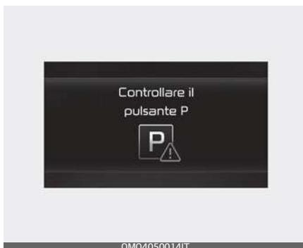
Il messaggio appare sul display LCD quando si verifica un problema con il pulsante P.
