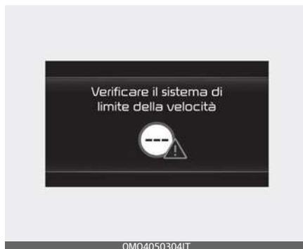
Quando la funzione Assistente limite di velocità intelligente non funziona correttamente, verrà visualizzato per alcuni secondi il messaggio di avviso e si accenderà la spia generale. In tal caso, si consiglia di far controllare la funzione da un concessionario/centro di assistenza partner autorizzato Kia.
