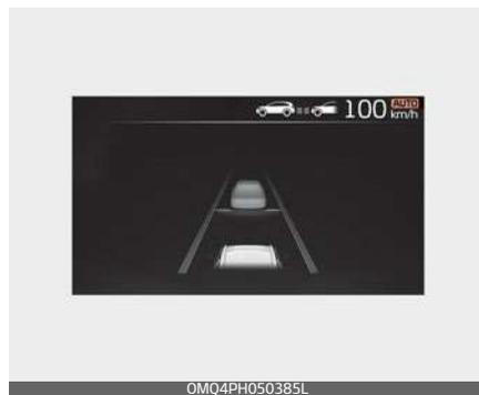
Se è richiesta una decelerazione temporanea nello stato di standby e lo Smart Cruise Control (Cruise Control intelligente) basato sulla navigazione è in funzione, il simbolo verde (**AUTO**) si accenderà sul quadro strumenti.
