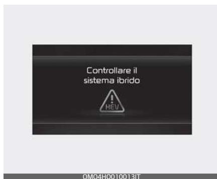
Questo messaggio viene visualizzato quando si verifica un problema relativo al sistema di controllo ibrido. Astenersi dal guidare quando è visualizzato il messaggio spia.
