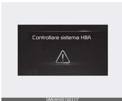
Quando il sistema High Beam Assist non funziona correttamente, comparirà il messaggio di avviso e la luce di avviso (⚠) si illuminerà sul quadro strumenti. Si consiglia di far ispezionare il veicolo da un concessionario/centro di assistenza partner autorizzato Kia.
