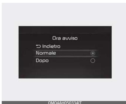
Con il pulsante ENGINE START/STOP (avviamento/arresto motore) in posizione ON, selezionare "Driver Assistance → Warning Timing" (Assistenza conducente → Temporizzazione avviso) nel menu Impostazioni per modificare il tempo di attivazione iniziale dell'avviso per il sistema di Assistenza anti collisione attraversamento da dietro.
