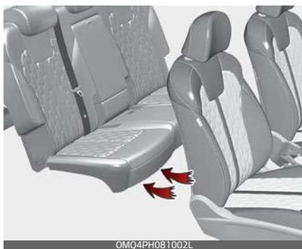
Il condotto di raffreddamento per batteria ibrida è posizionato a sinistra dei sedili posteriori. Serve a raffreddare la batteria ibrida. In caso di ostruzione del condotto di raffreddamento, la batteria può surriscaldarsi.
