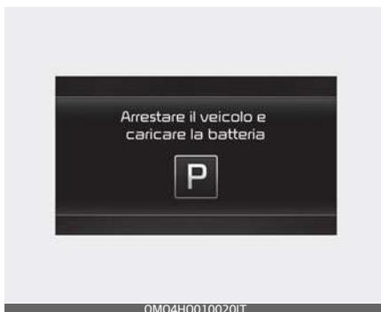
Questo messaggio viene visualizzato quando il livello di alimentazione della batteria ibrida (SOC) è basso.
