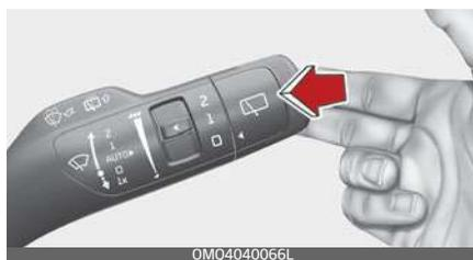
1. Portare l'interruttore di controllo della velocità del tergicristallo in posizione OFF (0).
