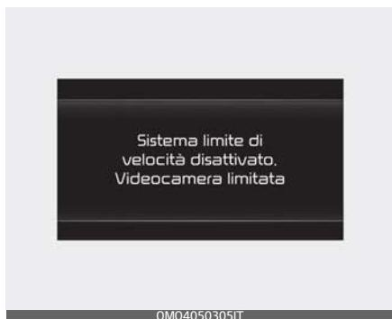
Quando il parabrezza sul quale è installata la camera per la visione anteriore è coperto da corpi estranei, come neve o pioggia, questo può ridurre le prestazioni di rilevamento e limitare temporaneamente o disabilitare l'Assistente limite di velocità intelligente.
