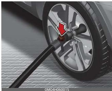
4. Svitare il cappuccio della valvola del pneumatico difettoso e avviare il tubo di riempimento della bomboletta di sigillante sulla valvola del pneumatico.
