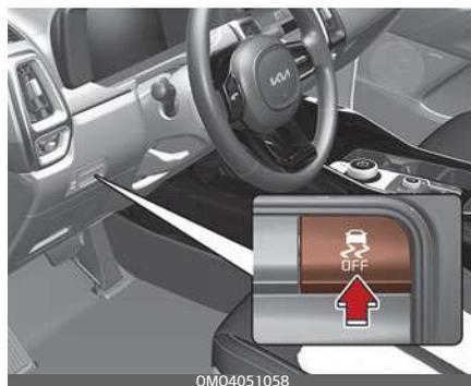
L'ESC applica la forza frenante sulle singole ruote e interagisce con il sistema di gestione del veicolo per stabilizzarlo.
