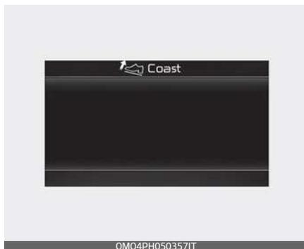
Il cicalino emette un suono e l'indicatore di Guida al coasting viene visualizzato per informare il conducente riguardo al momento in cui occorre rilasciare il pedale dell'acceleratore, anticipando così una decelerazione\* sulla base dell'analisi dei percorsi e delle condizioni stradali salvate nel sistema di navigazione. Invita il conducente a rilasciare il pedale e consente di percorrere la discesa solo con il motore EV. Serve per prevenire
