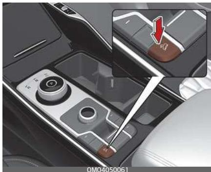
Il dispositivo di controllo freni in discesa (DBC) supporta il conducente nell'affrontare ripide discese senza dover premere il pedale del freno.
