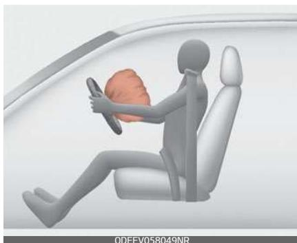
Al momento del gonfiaggio, le giunture a strappo praticate direttamente nei rivestimenti dei moduli si staccano per effetto della pressione prodotta dall'espansione degli airbag. L'ulteriore apertura dei rivesti-
