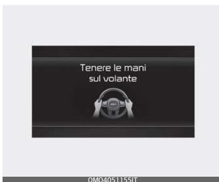
Se il conducente rimuove le mani dal volante per alcuni secondi, sul quadro strumenti viene visualizzato il messaggio di avviso 'Posizionare le mani sul volante' e un segnale acustico verrà emesso a fasi.
