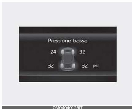
Quando gli indicatori spia del sistema di monitoraggio pressione pneumatici sono illuminati e viene visualizzato il messaggio spia sul display LCD quadro strumenti, vuol dire che uno o più pneumatici sono sotto-gonfiati in misura significativa. L'indicatore di pneumatico sgonfio segnala quale pneumatico è molto sgonfio accendendo la spia di posizione corrispondente.
