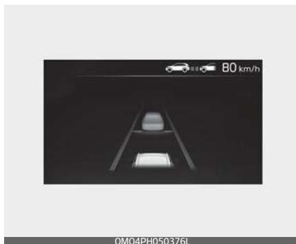
Se si desidera accelerare momentaneamente con lo Smart Cruise Control (Cruise Control intelligente) attivo, premere il pedale dell'acceleratore. Mentre la velocità aumenta, la velocità, il livello di distanza e la distanza target impostati lampeggeranno sul quadro strumenti.
