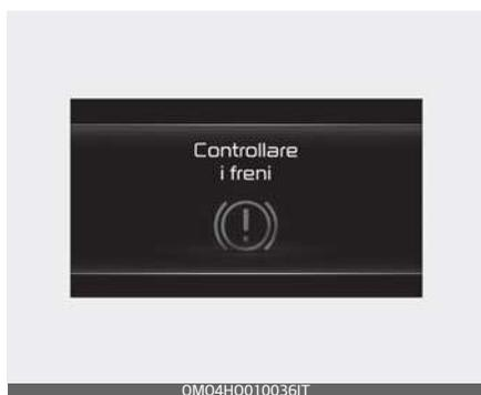
Questo messaggio viene visualizzato quando la funzionalità del freno è bassa o il freno rigenerativo non funziona a dovere a causa di un guasto nel sistema freno.
