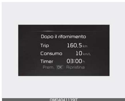
Il modo computer di viaggio mostra informazioni riguardanti i parametri di marcia del veicolo, compresi i consumi di carburante, la distanza per corsa e il timer.
