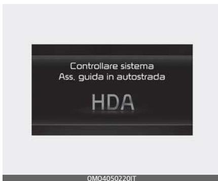
Quando l'Assistenza alla guida in autostrada non funziona adeguatamente, comparirà il messaggio di avviso di "Controllo del sistema di Assistenza alla guida in autostrada (HDA)" e sul quadro strumenti si accenderà la spia luminosa (⚠️). Far ispezionare la funzione da un concessionario autorizzato Kia.
