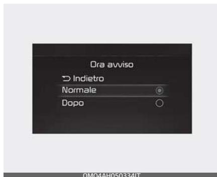
Con il pulsante ENGINE START/STOP (avviamento/arresto motore) in posizione ON, selezionare "Driver Assistance → Warning Timing" (Assistenza Conducente → Temporizzazione avviso) nel menu Impostazioni per modificare il tempo di attivazione iniziale dell'avviso per il Sistema di sicurezza dei punti ciechi.
