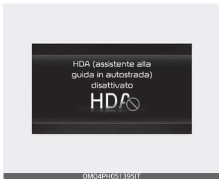
Se il conducente non ha ancora le mani sul volante dopo l'avviso, appare il messaggio di avviso "Sistema di Assistenza alla guida in autostrada (HDA) disattivato".
