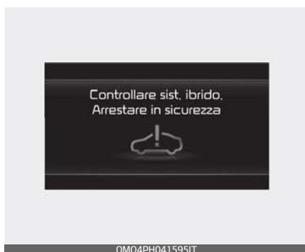
Questo messaggio viene visualizzato quando si verifica un problema relativo al sistema di controllo ibrido. L'indicatore "!" lampeggia e il cicalino emette un suono fino a quando il problema non sarà risolto. Astenersi dal guidare quando è visualizzato il messaggio spia.
