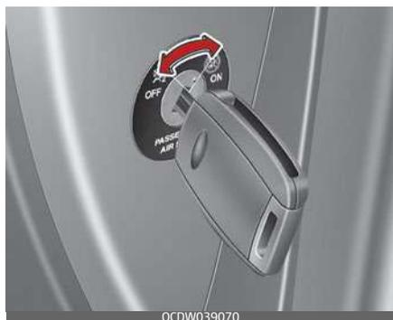
L'airbag frontale del passeggero si può disattivare, tramite un interruttore ON/OFF, nel caso in cui sul sedile del passeggero anteriore venga installato un seggiolino per bambini oppure quando il sedile non è occupato da nessuno.
