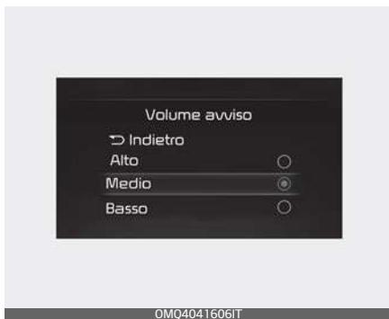
Con il pulsante Start/Stop del motore in posizione ON (Acceso), selezionare "Driver Assistance → Warning Volume" ("Assistenza conducente → Volume avviso") nel menu Impostazioni per impostare il volume dell'avviso su "High", "Medium", "Low" ("Alto", "Medio" o "Basso") per il sistema di Sicurezza dei punti ciechi.
