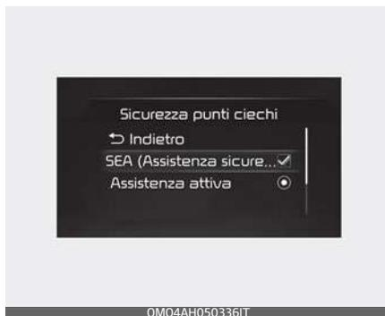
Con il pulsante ENGINE START/STOP (avviamento/arresto motore) in posizione ON, selezionare "Driver Assistance → Blind-Spot Safety → Safe Exit Assist" ("Assistenza conducente → Sicurezza dei punti ciechi → Assistenza per l'uscita sicura dal veicolo") nel menu Impostazioni per attivare l'Assistenza per l'uscita sicura dal veicolo, e deselezionare per disattivare la funzione.
