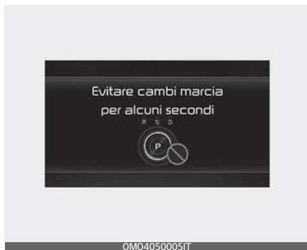
Il messaggio appare sul display LCD quando si seleziona P (parcheggio) o quando il cambio è surriscaldato.
