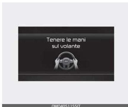
Se il conducente rimuove le mani dal volante per alcuni secondi, sul quadro strumenti viene visualizzato il messaggio di avviso "Posizionare le mani sul volante" (Keep hands on the steering wheel) e un segnale acustico verrà emesso a fasi.
