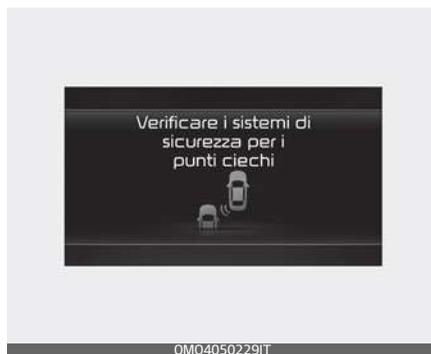
Quando il Sistema di sicurezza dei punti ciechi non funziona correttamente, il messaggio di avviso "Controllare il Sistema di sicurezza dei punti ciechi" apparirà sul quadro strumenti e la funzione di sicurezza dei punti ciechi si disattiverà automaticamente o sarà limitata. Far ispezionare la funzione da un concessionario autorizzato Kia.
