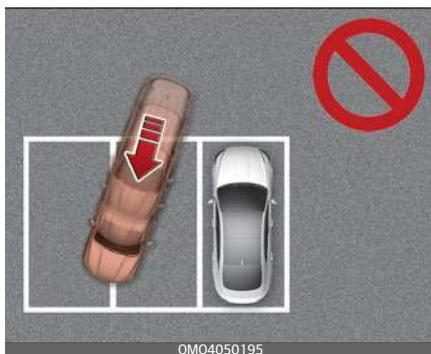
Se si utilizza l'Assistenza di parcheggio intelligente a distanza, quando si parcheggia in un parcheggio con un veicolo solo su un lato, il veicolo può attraversare la linea di parcheggio per evitare il veicolo parcheggiato.
