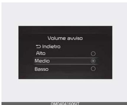
Con il pulsante Start/Stop del motore in posizione ON (Acceso), selezionare "Driver Assistance → Warning Volume" ("Assistenza conducente → Volume avviso") nel menu Impostazioni per impostare il volume dell'avviso su "High", "Medium", "Low" ("Alto", "Medio" o "Basso") per l'Avviso mani staccate dal volante.
