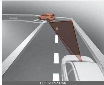
Nelle curve, lo Smart Cruise Control (Cruise Control intelligente) potrebbe non rilevare un veicolo nella stessa corsia, e potrebbe accelerare per raggiungere la velocità impostata. Inoltre, la velocità si riduce rapidamente quando viene rilevato improvvisamente il veicolo che precede. Selezionare la velocità impostata appropriata sulle curve e usare il pedale del freno o dell'acceleratore in base alle condizioni della strada e di guida davanti.
