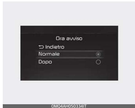
Con il pulsante ENGINE START/STOP (avviamento/arresto motore) in posizione ON, selezionare "Driver Assistance → Warning Timing" (Assistenza conducente → Temporizzazione avviso) nel menu Impostazioni per modificare il tempo di
