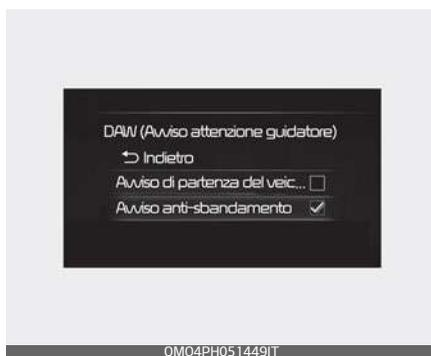
Con il pulsante ENGINE START/STOP (avviamento/arresto motore) in posizione ON, selezionare o deselezionare "Driver Assistance → Driver Attention Warning" (Assistenza conducente → Avviso di attenzione del guidatore) nel menu Impostazioni per stabilire se avvalersi o meno di ciascuna funzione.
