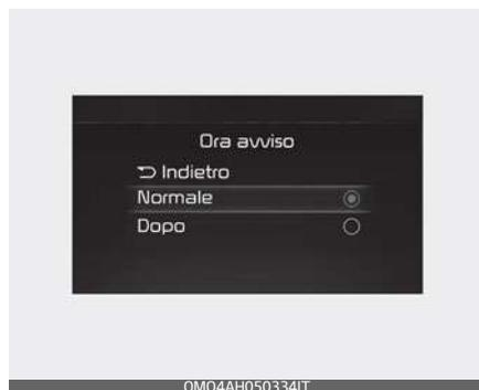
Con il pulsante ENGINE START/STOP (avviamento/arresto motore) in posizione ON, selezionare "Driver Assistance → Warning Timing" (Assistenza conducente → Temporizzazione avviso) nel menu Impostazioni per modificare il tempo di attivazione iniziale dell'avviso per il sistema di Assistenza anti-collisione anteriore.
