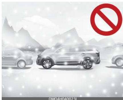
La neve può interferire con il funzionamento dei sensori, oppure il sistema Assistenza parcheggio intelligente a distanza può disattivarsi se la strada è scivolosa durante il parcheggio.
