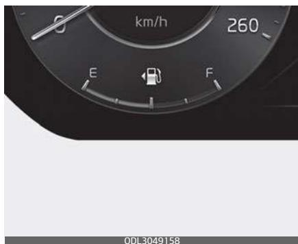
L'indicatore del livello carburante indica approssimativamente la quantità di carburante presente nel serbatoio.
