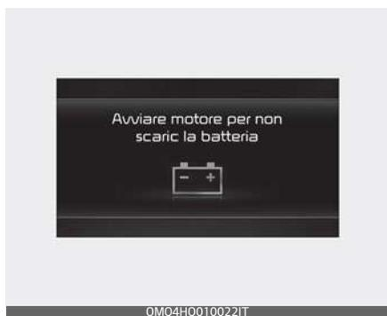
Se il motore non viene acceso con il pulsante ENGINE START/STOP (avviamento/arresto motore) in ACC o ON per un certo periodo, la batteria può scaricarsi. Si prega di accendere il motore per evitare che la batteria a 12V si scarichi.
