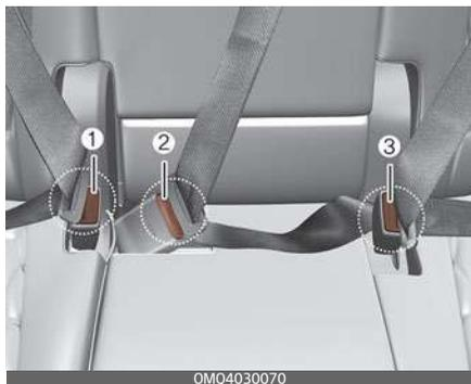
1. Fibbia di bloccaggio cintura di sicurezza posteriore destra
