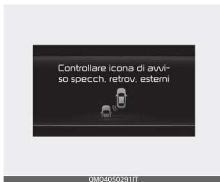
Quando la spia dello specchietto laterale non funziona correttamente, sul quadro strumenti viene
