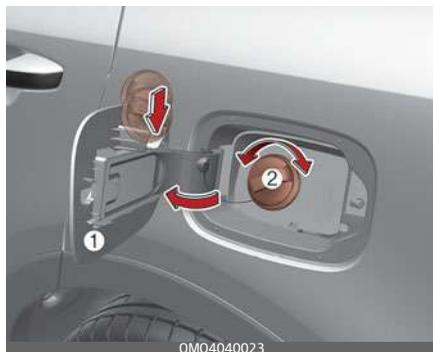
5. Per rimuovere il tappo serbatoio carburante (2), ruotarlo in senso antiorario. Si potrebbe sentire un sibilo dovuto alla stabilizzazione della pressione all'interno del serbatoio.
