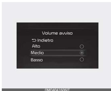
Con il pulsante Start/Stop del motore in posizione ON (Acceso), selezionare "Driver Assistance → Warning Volume" ("Assistenza conducente → Volume avviso") nel menu Impostazioni per impostare il volume dell'avviso su "High", "Medium", "Low" ("Alto", "Medio" o "Basso") per l'Assistenza anti-collisione anteriore.
