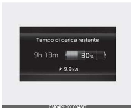
10. Una volta che la carica si è avviata, il tempo di carica stimato viene visualizzato sul quadro strumenti per circa 1 minuto. La
