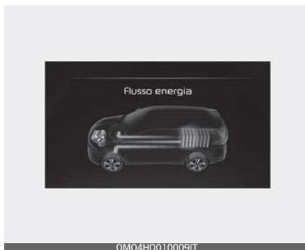
Il motore termico ricarica la batteria ad alta tensione. Il veicolo è azionato solo dal motore elettrico.
