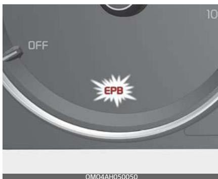
Se l'indicatore di EPB malfunzionante rimane acceso, si accende a veicolo in marcia o non si accende quando il pulsante ENGINE START/STOP (avvio/arresto motore) viene smistato nella posizione ON, ciò indica un possibile malfunzionamento dell'EPB.
