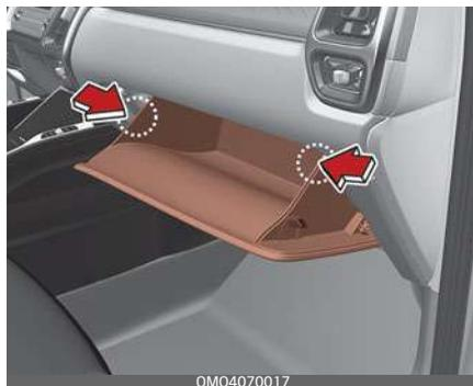
3. Rimuovere il coperchio filtro aria climatizzatore estraendo entrambi i lati della copertura.
