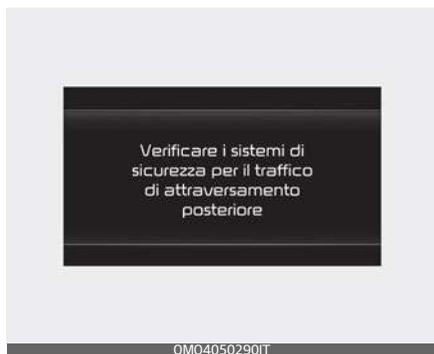
Quando l'Assistenza anticollisione attraversamento da dietro non funziona correttamente, sul quadro strumenti apparirà il messaggio "Controllare il sistema Sicurezza traffico di attraversamento posteriore" e la funzione si disattiverà automaticamente o sarà limitata. Far ispezionare la funzione da un concessionario autorizzato Kia.
