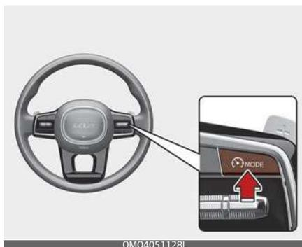
Premere il pulsante di Assistenza alla guida (⌚ MODE) per disattivare lo Smart Cruise Control (Cruise Control intelligente).
