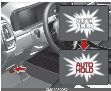
Quando si arriva ad un arresto completo premendo il pedale del freno, l'indicatore AUTO HOLD cambia da bianco a verde, segnalando che l'AUTO HOLD è inserito. Il veicolo rimane fermo anche se si rilascia il pedale del freno.
