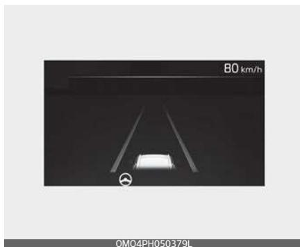
Se il veicolo che precede e/o entrambe le strisce di delimitazione sono rilevati e la velocità del proprio veicolo è inferiore a 200 km/h (120 mph), sul quadro strumenti si accenderà la spia verde (🚗) e la funzione aiuterà il veicolo a rimanere in corsia assistendo il volante.
