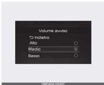
Con il pulsante Start/Stop del motore in posizione ON (Acceso), selezionare "Driver Assistance → Warning Volume" ("Assistenza conducente → Volume avviso") nel menu Impostazioni per impostare il volume dell'avviso su "High", "Medium", "Low" ("Alto", "Medio" o "Basso") per il sistema Smart Cruise Control (Cruise Control intelligente).
