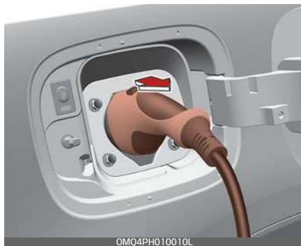
Per evitare il furto del cavo di carica, il connettore di carica non può essere scollegato dalla presa quando le porte sono bloccate. Tuttavia, se il veicolo si trova nel modo AUTO del connettore di carica, il connettore di carica si sblocca automaticamente dalla presa quando la carica è completata.
