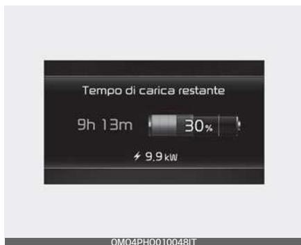
Il messaggio visualizza il tempo di carica restante per la carica completa della batteria.
