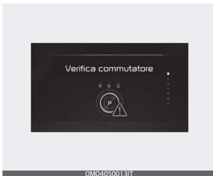
Il messaggio appare sul display LCD quando si verifica un problema con il quadro SBW.
