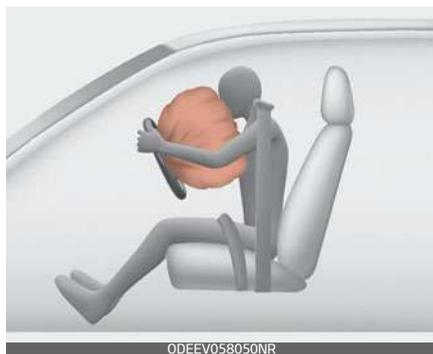
Il completo intervento dell'airbag, unitamente all'azione della cintura di sicurezza, attutiscono l'impatto del conducente o del passeggero contro l'interno del veicolo, riducendo così il rischio di lesioni alla testa o al torace.
