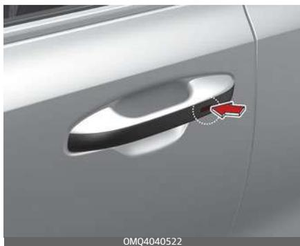
Portando con sé la chiave intelligente, è possibile bloccare e sbloccare le porte (e il portellone). È inoltre possibile avviare il motore. Fare riferimento a quanto segue per maggiori dettagli.
