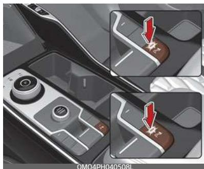
Premere il pulsante Sicurezza durante il parcheggio (P<sup>W</sup>) per attivare o disattivare l'Avviso di distanza di parcheggio in retromarcia.
