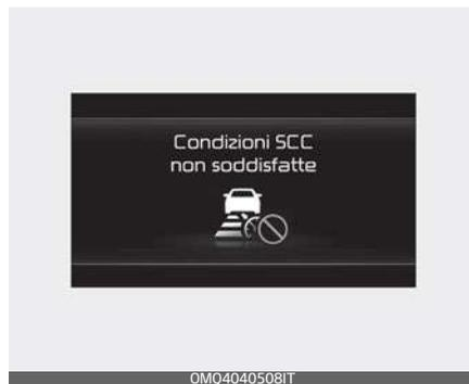
Se si preme il pulsante di Assistenza alla guida (MODE), il pulsante +, il pulsante - o il pulsante (||) quando le condizioni operative della funzione non sono soddisfatte, sul quadro strumenti verrà visualizzato il messaggio "Smart Cruise Control conditions not met" ("Condizioni
