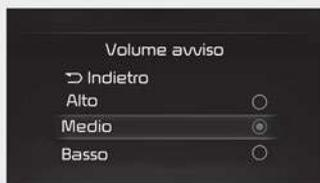
Con il pulsante Start/Stop del motore in posizione ON (Acceso), selezionare "Driver Assistance → Warning Volume" ("Assistenza conducente → Volume avviso") nel Menu Impostazioni per impostare il volume dell'avviso su "High", "Medium", "Low" ("Alto", "Medio" o "Basso") per il sistema Rear Cross-Traffic Safety ("Sicurezza traffico di attraversamento posteriore").
