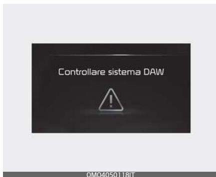
Quando l'Avviso attenzione guidatore non funziona correttamente, viene visualizzato il messaggio "Controllare sistema DAW" sul quadro strumenti. In tal caso, si consiglia di far ispezionare il veicolo da un concessionario/centro di assistenza partner autorizzato Kia.
