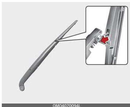
Se la sostituzione è completa, abbassare il braccio del tergicristallo per posizionarlo sul lunotto posteriore e portare l'accensione del veicolo su ON e azionare i tergicristalli per verificare che la lama sia installata correttamente.
