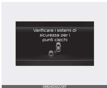
Quando l'Assistenza per l'uscita sicura dal veicolo non funziona correttamente, il messaggio di avviso "Controllare il Sistema di sicurezza dei punti ciechi" apparirà sul quadro strumenti e la funzione di sicurezza dei punti ciechi si disattiverà automaticamente o sarà limitata. Far ispezionare la funzione da un concessionario autorizzato Kia.
