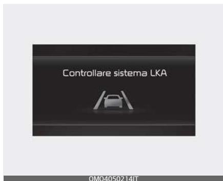
Quando l'Assistenza mantenimento corsia non funziona correttamente, viene visualizzato il messaggio e sul quadro strumenti si accende la spia gialla dell'indicatore (🚗). Se si verifica questa condizione, far ispezionare la funzione da un concessionario autorizzato Kia.
