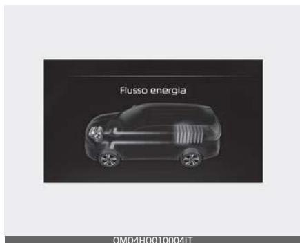
Il sistema ibrido notifica al conducente il flusso di energia in diverse modalità operative. Durante la guida, il flusso di energia corrente è definito da 11 diverse modalità.
