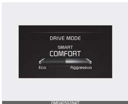
Sullo schermo vengono visualizzati la modalità drive selezionata dal conducente e l'indicatore dello stile di guida che mostra lo stile di guida del conducente.
