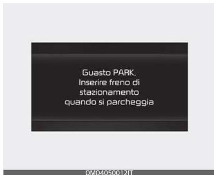
Il messaggio viene visualizzato quando si verifica un problema con la funzione che impegna la posizione P (Parcheggio).
