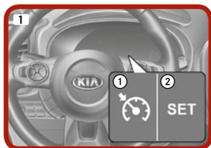
Sistema di regolazione automatica di velocità/Cruise Control\* [5]
