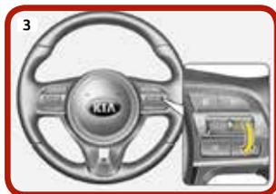
Regolare la velocità portando la leva in posizione SET -
