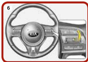
Per ripristinare la velocità di crociera muovere la leva in posizione RES +
