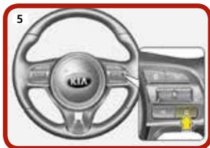
Azzerare la velocità impostata sul sistema di regolazione premendo il relativo pulsante o il pedale del freno
