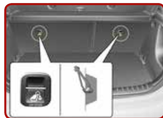
Fissaggio con sistema di "ancoraggio flessibile**" [3]
