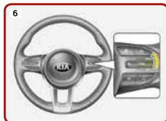
Per ripristinare la velocità di crociera muovere la leva in posizione RES +
