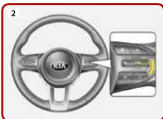
Regolare la velocità portando la leva in posizione SET +
