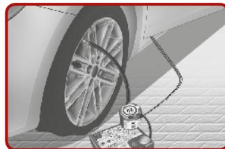
Il TireMobilityKit consente di proseguire il viaggio anche in caso di foratura. Una volta verificato che lo pneumatico è stato correttamente riparato, si può continuare la marcia (fino ad una percorrenza di 200 km) senza superare la velocità di 80 km/h, in modo da raggiungere un gommista o un'autofficina.
