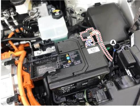
b) Rimuovere la protezione del service plug (A) dopo aver rimosso removing il sedile posteriore.
