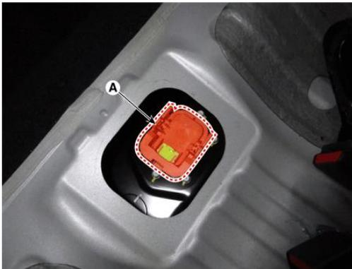
5. In caso di emergenza, tagliare il connettore dell'interblocco di servizio cavo per isolare l'alta tensione della batteria.
