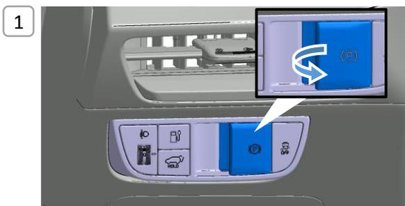
1. Bloccare le ruote e tirare l'interruttore per inserire il freno di stazionamento.
