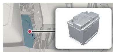
3. La batteria è nel vano motore
