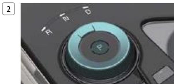
2. Per i veicoli con cambio automatico, inserire la posizione di parcheggio (P).
