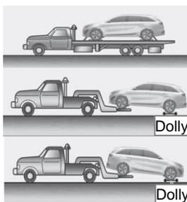
N.B.: È consigliato l'uso di carrelli idraulici o di un pianale. Utilizzare un sollevatore ruote o un pianale.
