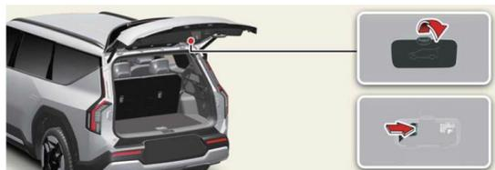
Rimuovere la copertura nella parte inferiore del portellone, poi far scorrere il fermo nella direzione della freccia per aprire il portellone.
