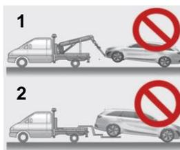
N.B.: Non trainare con un sistema di imbracatura (1). Non trainare il veicolo con le ruote anteriori a terra, in quanto si potrebbe danneggiare il veicolo (2).
