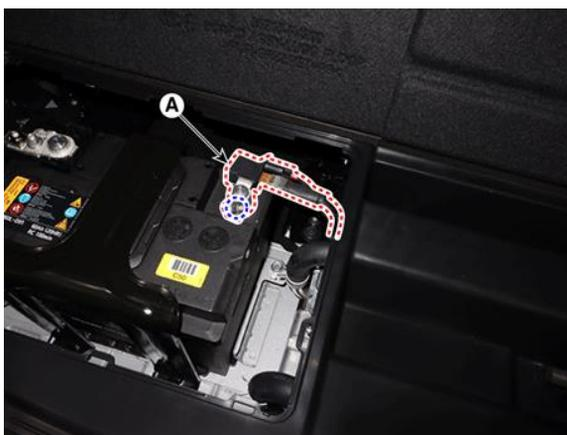
b) Scollegate il connettore interlock service (A) nel vano motore.
